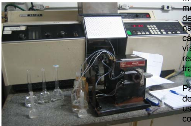
Figura 11 – Leitura do mercúrio nas amostras de surubins utilizando o gerador de hidretos
