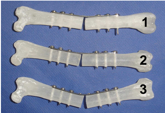
FIGURA 9: Fotografia dos corpos de prova constituídos do modelo ósseo seccionado no terço médio e fixado com microplaca de aço reta de 2mm, com oito orifícios, após os ensaios de flexão com quatro pontos realizado com uma máquina universal de ensaios EMIC DL 3000 com célula de carga de 2000N. Os corpos de prova estão enumerados de acordo com a ordem de realização dos ensaios. Observar a deformação da placa na região adjacente à linha de secção do modelo acrílico.
