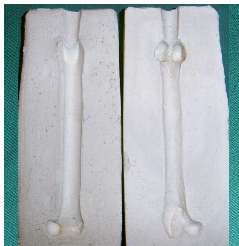
FIGURA 2: Fotografia do molde de gesso utilizado para confeccionar os modelos de fêmur esquerdo de gato em metilmetacrilato.
