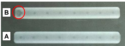
FIGURA 29: Imagem radiográfica de duas placas de compósito de PHB (70%) e HA (30%) pertencentes ao segundo lote. A - placa sem bolhas selecionada para utilização no experimento. B - placa com bolha (circulo vermelho) que foi descartada.
