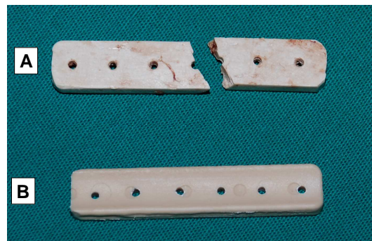
FIGURA 32: Fotografia de duas placas de compósito de PHB (70%) e HA (30%) uma íntegra (B) e outra após ser retirada do animal, apresentando ruptura oblíqua curta passando por um dos orifícios centrais (A).
