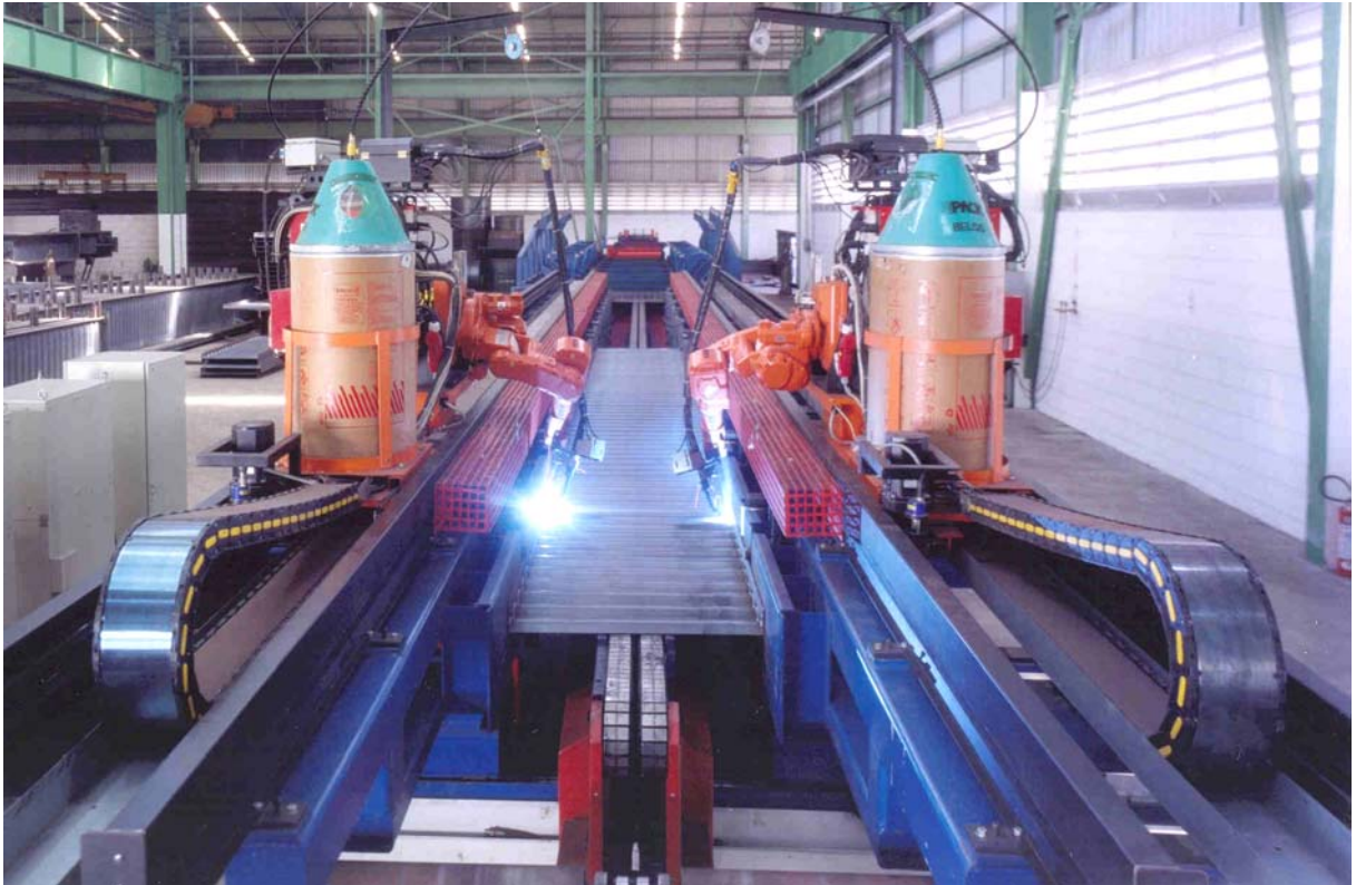
Figura 1.4 – Fabricação de peças de alma senoidal – Codeme Engenharia S.A.
