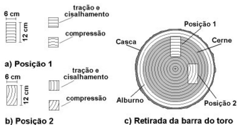
**Figura 52 – Posição da retirada das barras e orientação de seus anéis de crescimento.**
