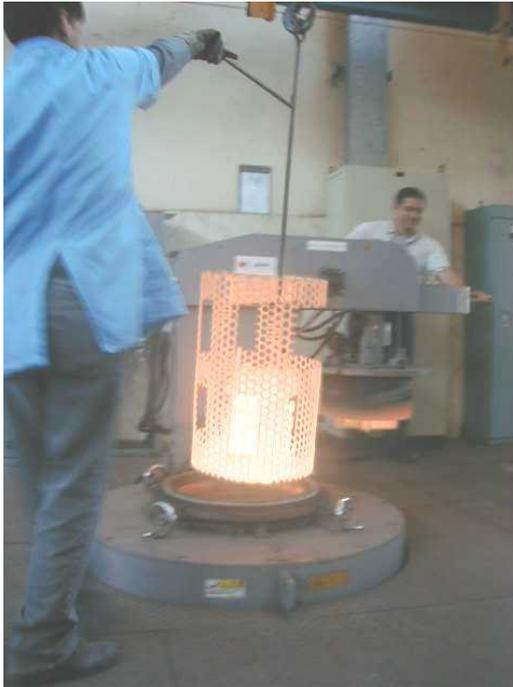
FIGURA 3.8 – Retirada do cesto do forno de austenitização à temperatura de 900°C.
