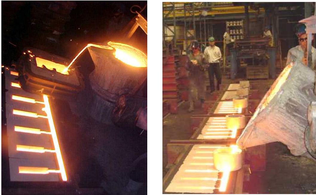
FIGURA 3.3 – Preenchimento dos moldes com metal líquido.
