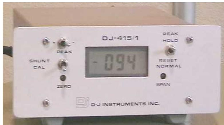
FIGURA 3.21 – Indicador digital da célula de carga.
