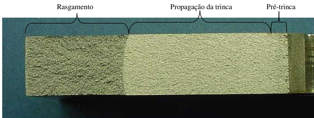
FIGURA 4.10 – Superfície de fratura de corpos-de-prova tipo CT utilizados em ensaios de propagação de trinca por fadiga do ADI-T1 sob carregamento de amplitude de carga constante.
