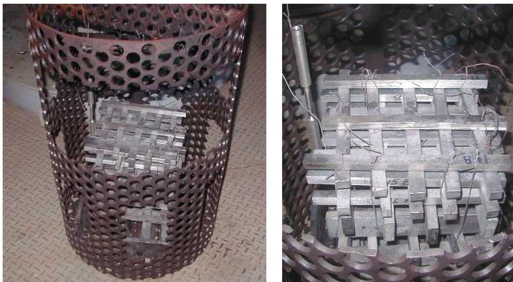
FIGURA 3.7 – Cesto metálico com as barras preparadas para o tratamento térmico.
