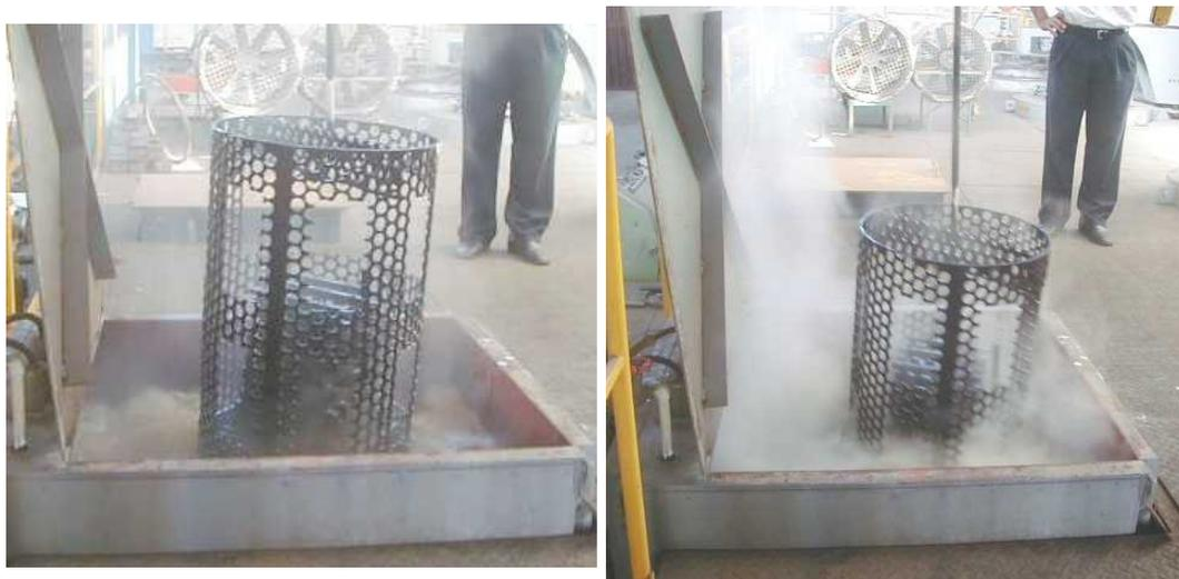
FIGURA 3.12 – Resfriamento e limpeza das barras em tanque de água à 60°C com agitação por ar comprimido.
