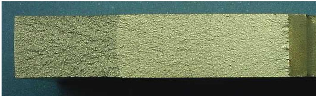
FIGURA 4.31 – Superfície de fratura de corpos-de-prova tipo CT utilizados em ensaios de propagação de trinca por fadiga do ADI-T2. Carregamento em blocos, conforme FIG. 4.18.
