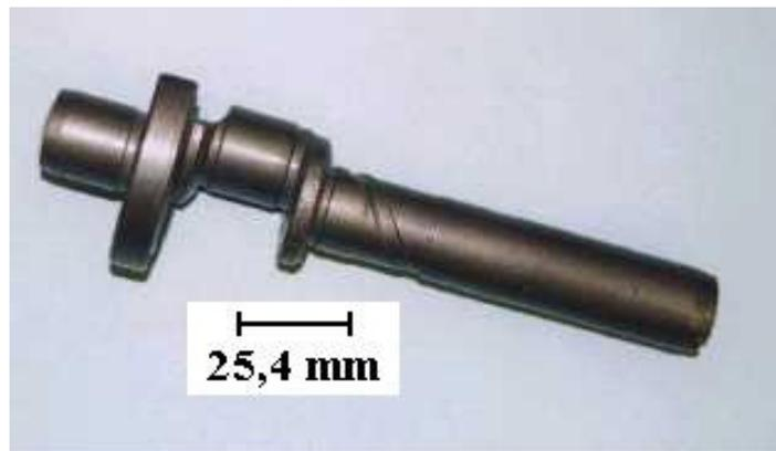
FIGURA 2.4 – Eixo virabrequim para compressor de ar, em ADI, fabricado em 1972.
