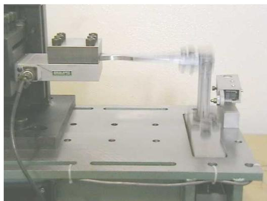
FIGURA 3.19 – Célula de carga, corpo-de-prova e base oscilante durante um ensaio.
