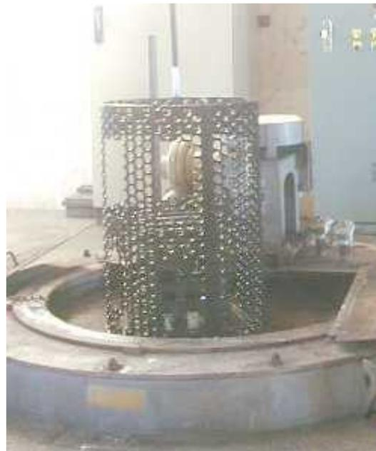
FIGURA 3.11 – Retirada do cesto do forno após a austêmpera.
