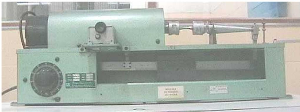
FIGURA 3.15 – Máquina de ensaio de fadiga por flexão rotativa, RBF-200.
