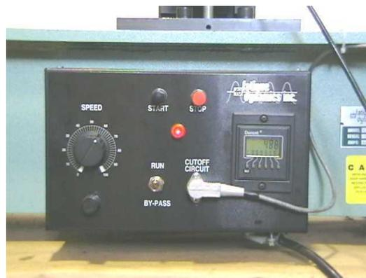
FIGURA 3.20 – Sistema de controle da rotação e do número de ciclos.
