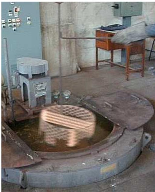
FIGURA 3.10 – Término da imersão do cesto no forno de austêmpera.
