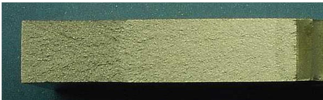
FIGURA 4.11 – Superfície de fratura de corpos-de-prova tipo CT utilizados em ensaios de propagação de trinca por fadiga do ADI-T2 sob carregamento de amplitude de carga constante.
