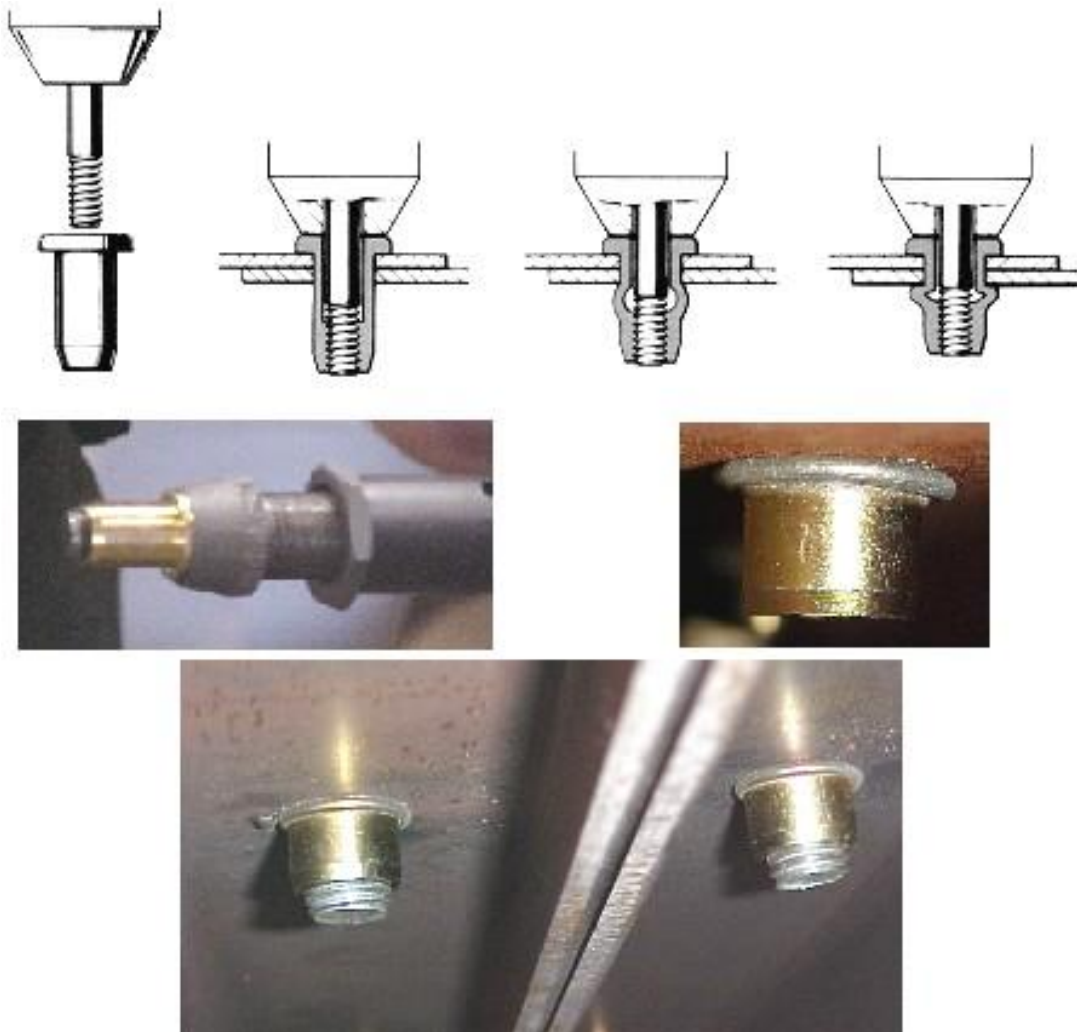
FIGURA 3.8 – Etapas de instalação da porca-rebite.
