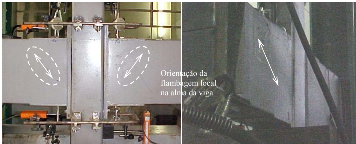
FOTO 4.15 – Efeito de flambagem local na alma das vigas do modelo 04BR-01.
