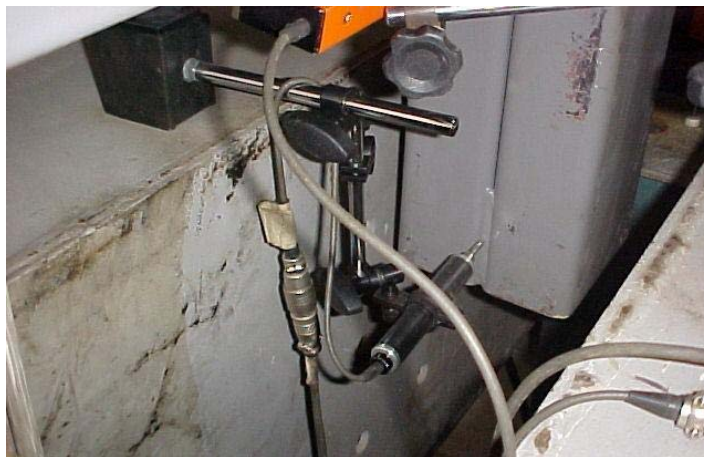
FOTO 3.8 – DT_{25} realizando medição do deslocamento horizontal do modelo.
