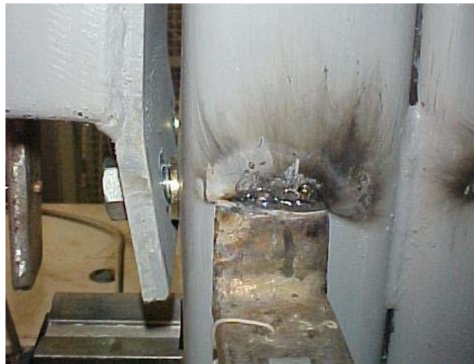
FOTO 4.13 – Deformação por tração dos parafusos inferiores nos modelos 04AF.
