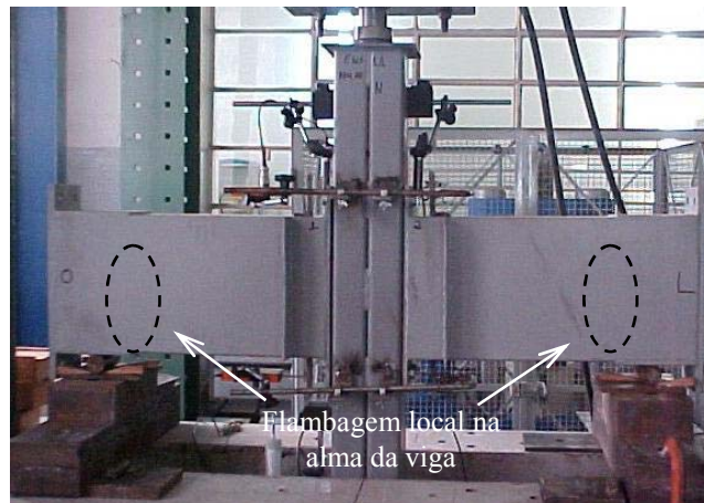
FOTO 4.14 – Efeito de flambagem local na alma das vigas do modelo 04AF-01.
