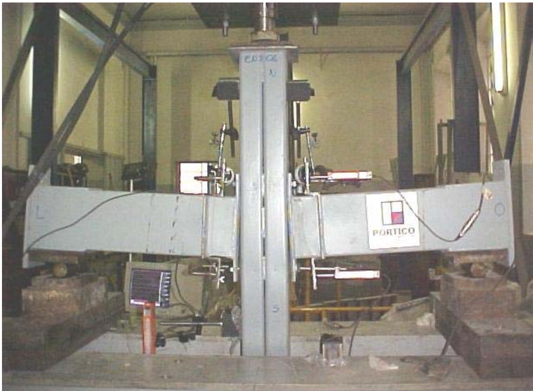
FOTO 4.1 – Aspecto geral do modelo 01AF-01 no fim do ensaio.
