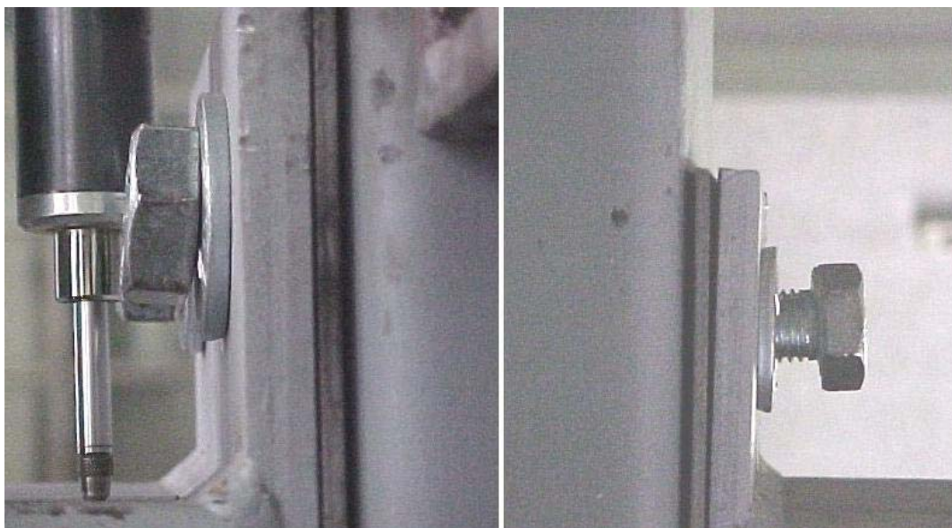
FOTO 4.3 – Deformação visível dos parafusos do modelo 01AF-03.
