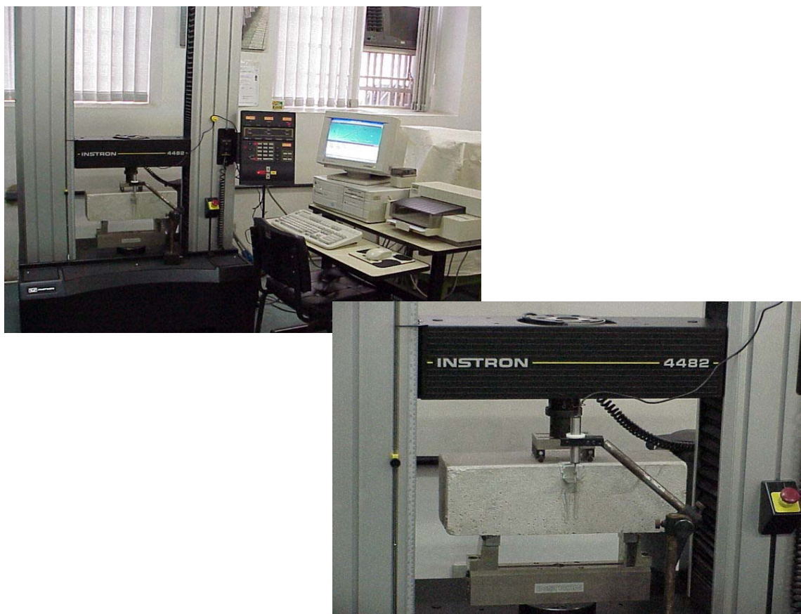
FIGURA 3.4a - Fotografia da montagem para ensaios de fadiga.
