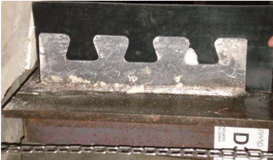
FIGURA 4.7 – Aspecto do conector Crestbond-PL ao final do ensaio
