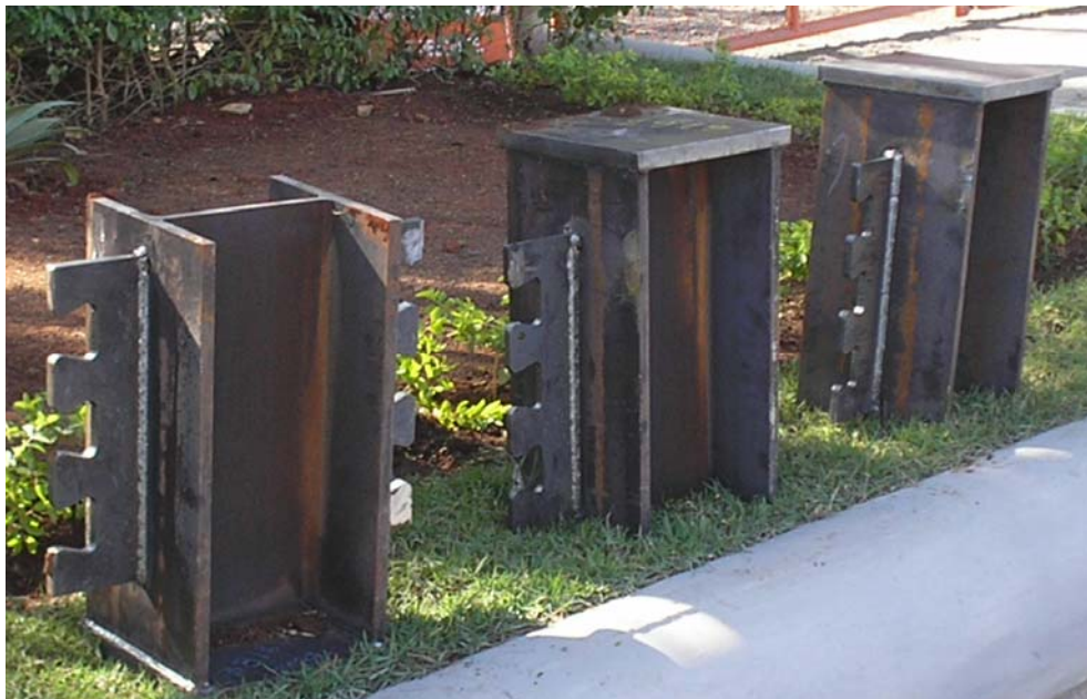
FIGURA 3.13 – Detalhes dos conectores soldados ao perfil metálico (OLIVEIRA et al. , 2006).
