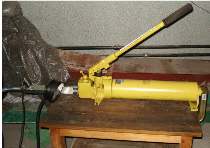
FIGURA 3.32 – Transdutor de pressão e manômetro ligados na saída da bomba.
