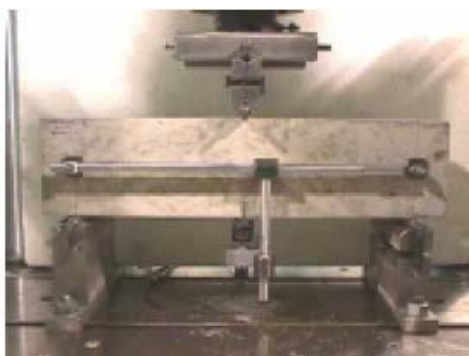
Figura 2.14 – Esquema do ensaio de viga entalhada da RILEM – TC 162 (BARRAGÁN, 2002)
