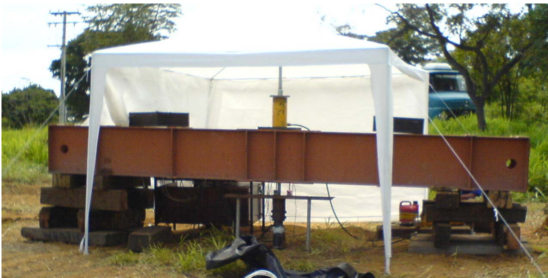
FIGURA 5.10 Sistema de ação e reação à tração.
