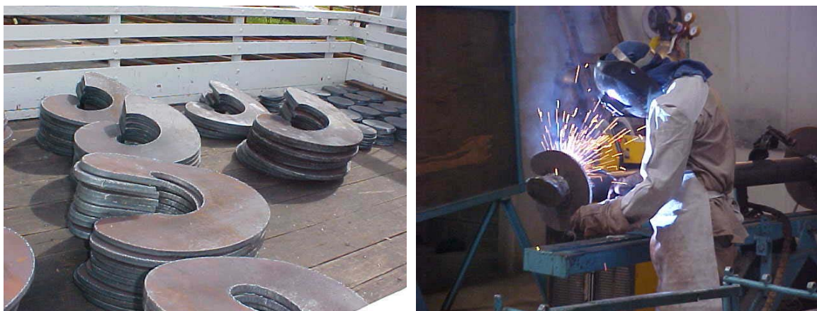
a) FIGURA 2.1 a) Hélices; b) Soldagem da hélice ao fuste.
