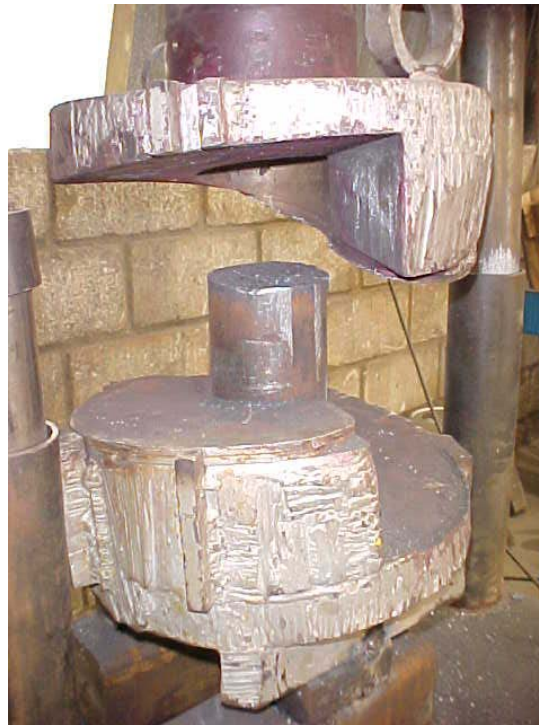
FIGURA 2.2 Molde de deformação das hélices.
