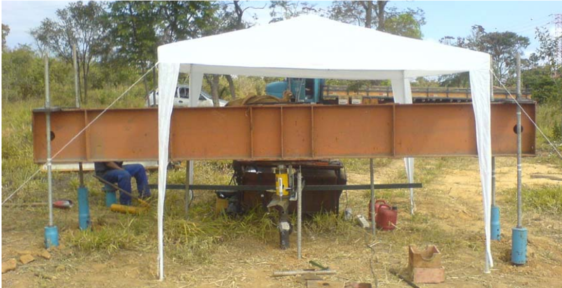
FIGURA 5.11 Sistema de ação e reação à compressão.
