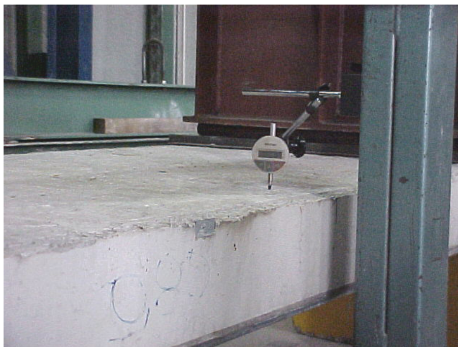
Figura 4.7 – Detalhe do relógio comparador para medição da flecha no meio do vão
