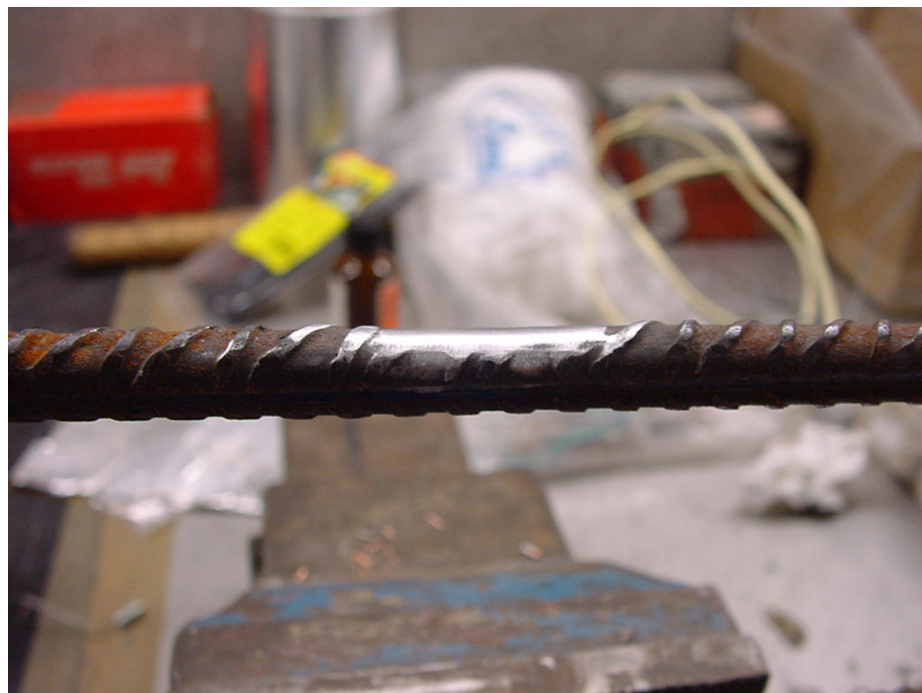
FIGURA 3.16 – Aspecto da barra de aço após desbaste das mrossas aplicação da lixa.
