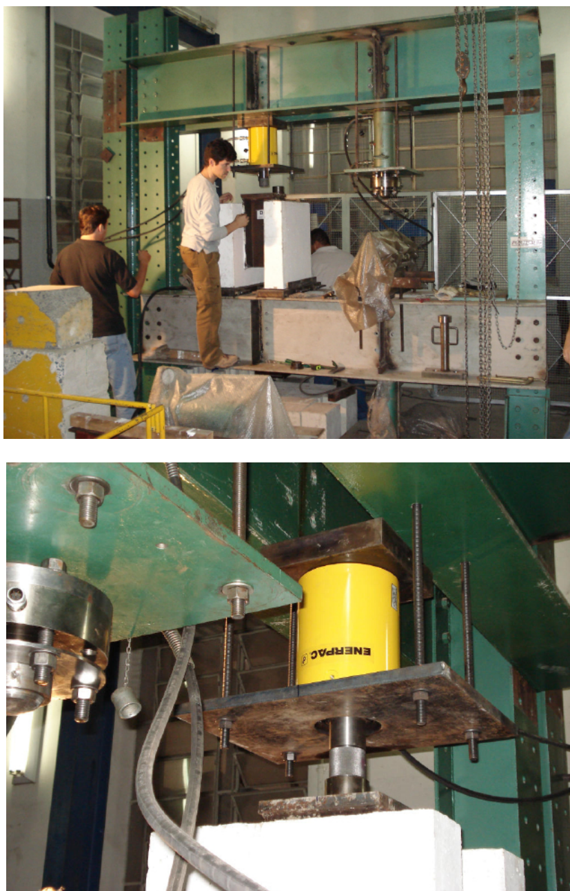
FIGURA 3.95 – Montagem do macaco hidráulico no pórtico de reação - série D.
