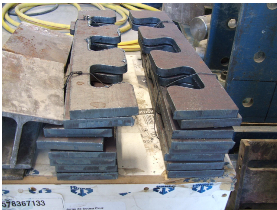
conectores CR56b cortados a oxiacorte em Portugal
