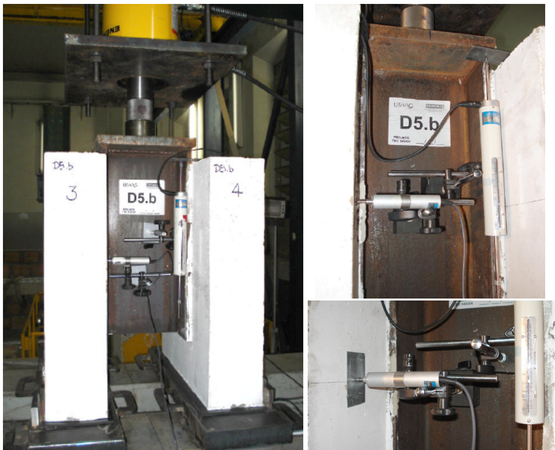
FIGURA 3.99 – Posicionamento dos transdutores de deslocamento.
