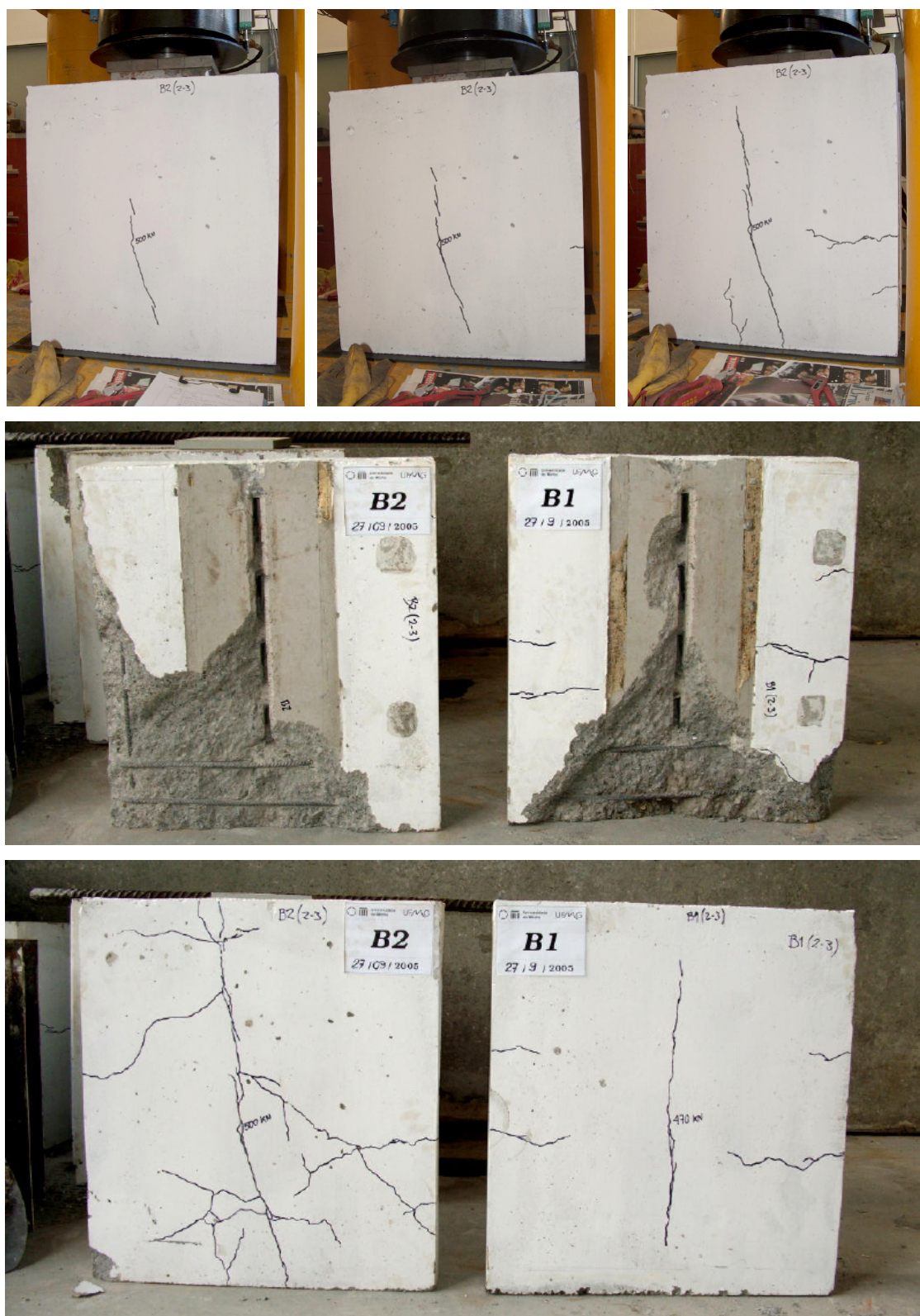
FIGURA 3.70 – Modelos B1 e B2 – sem armadura passante ( f_c = 26,6 MPa) – aspecto da ruptura das lajes.
