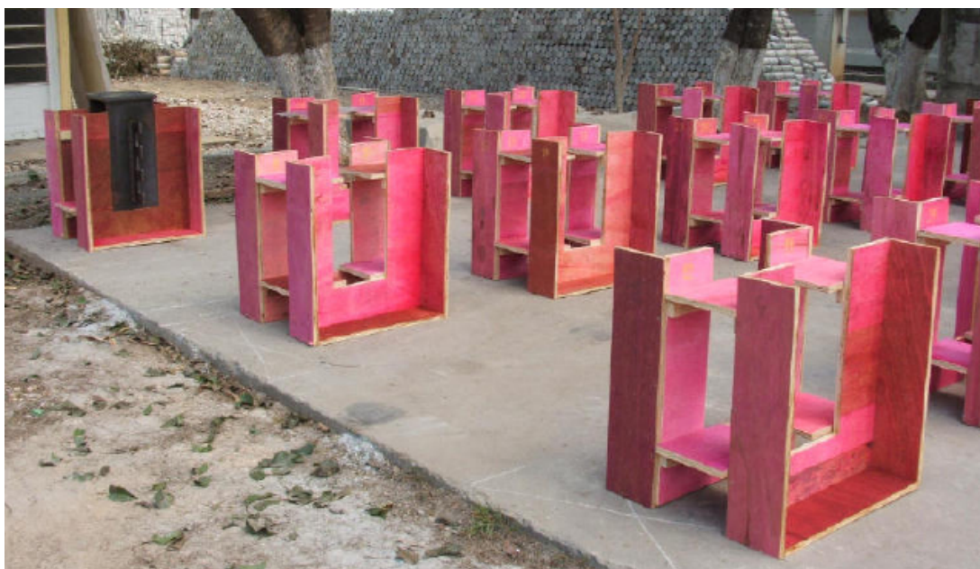
FIGURA 3.83 – Montagem das fôrmas - série D.
