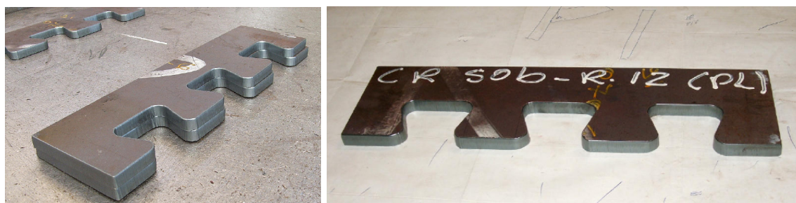
FIGURA 3.79 – Conectores CR56b-PL cortados na CODEME em aço USI-CIVIL 350.
