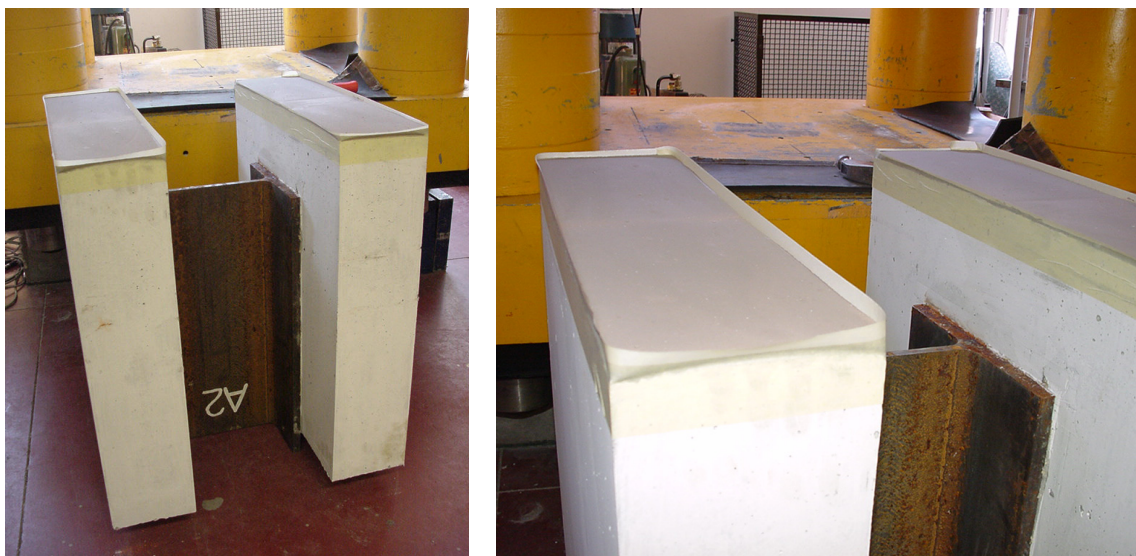
FIGURA 3.24 – Regularização das lajes com argamassa auto-nivelante.
