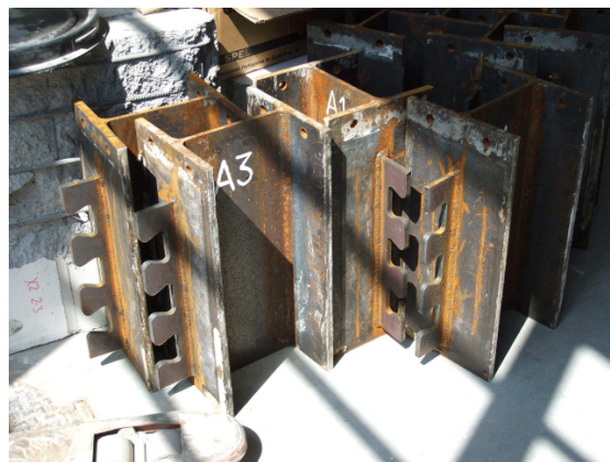
conectores CR56b montados nos perfis para a série B
