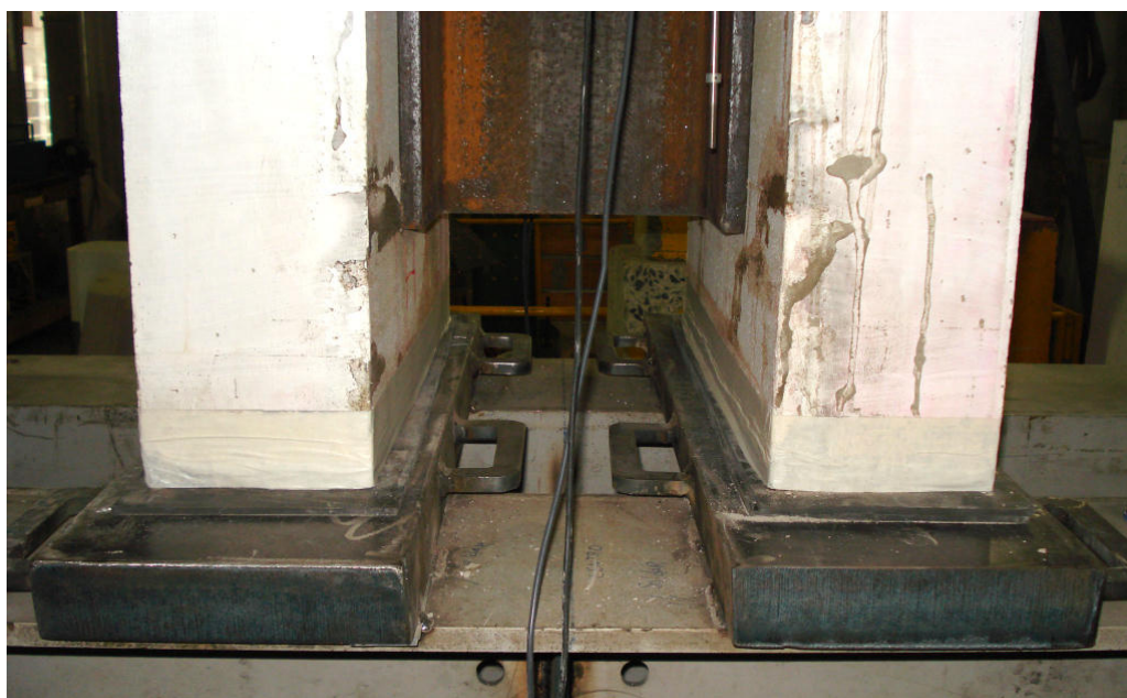
FIGURA 3.100 – Montagem sem as barras de contenção lateral – série D.
