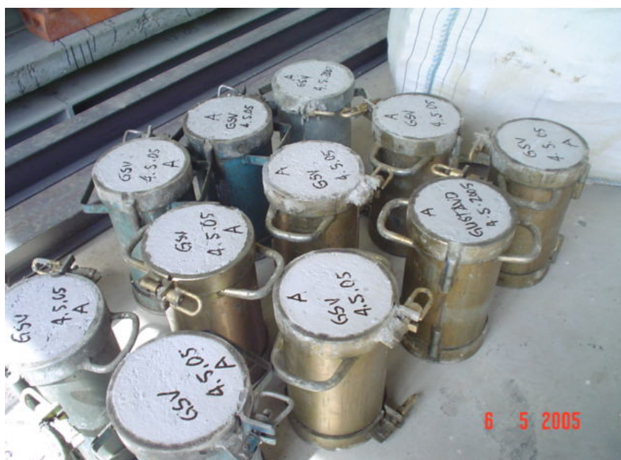
FIGURA 3.38 – Corpos-de-prova cilíndricos para caracterização do concreto.
