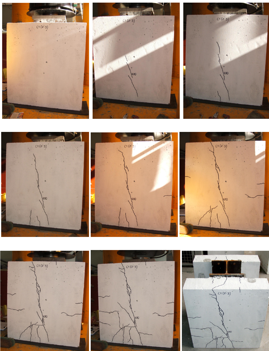
FIGURA 3.73 – Modelo C1 – sem armadura passante ( f_c = 46,9 MPa) – progressão da fissuração na laje durante o carregamento.
