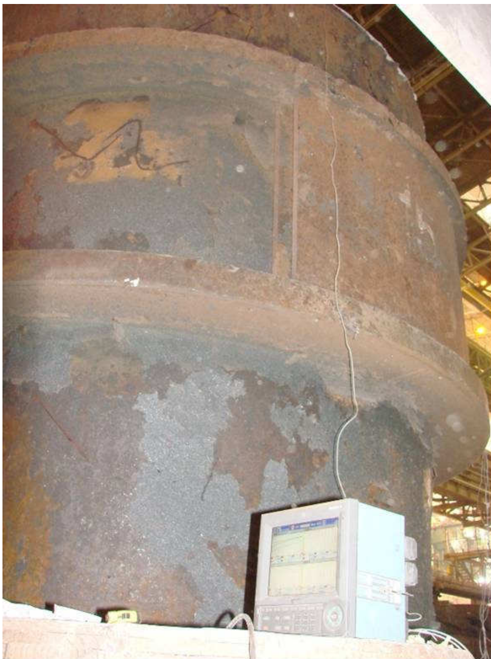
Figura 4.7: Visão externa da panela instrumentada com registrador de dados.
