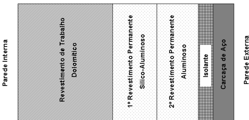
Figura I.1: Nomeclatura das diversas camadas refratárias da lateral da panela.
