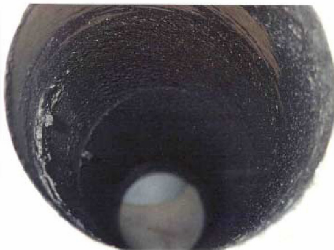
Figura 3.15 – tubo poroso retirado de um sistema de flotação ASH, recoberto por incrustações (Miller et al. , 2001).
