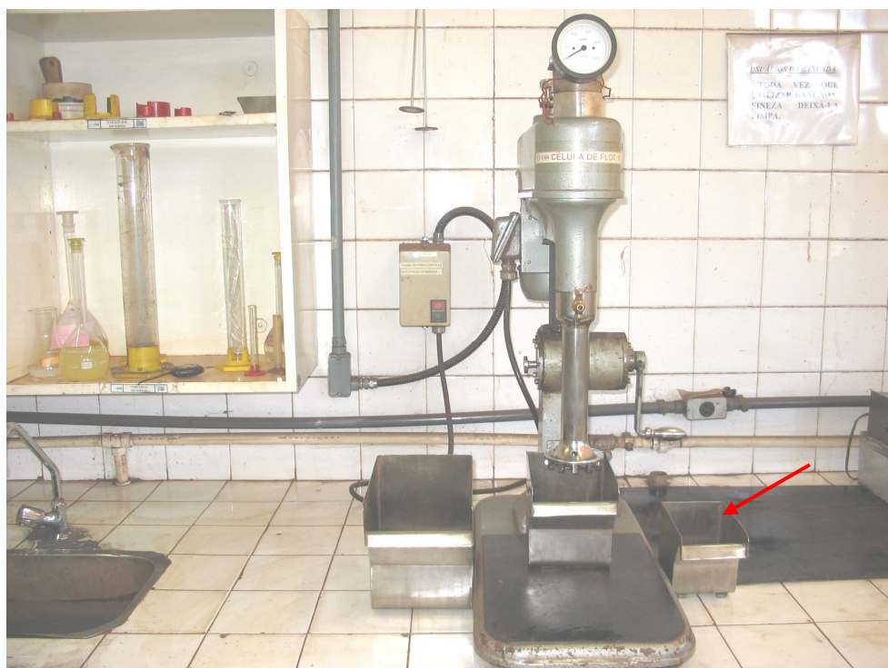
Figura 4.2 - célula de flotação utilizada nos testes em escala de bancada com destaque para a cuba de 700cm 3 (CSN, 2001).
