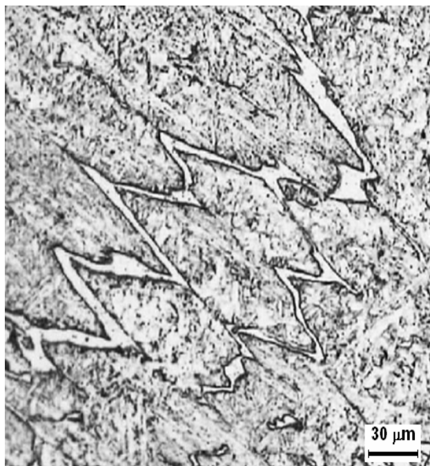
Figura 3.11. Rede de ferrita delta em uma matriz martensítica revenida (OÑORO, 2006).
