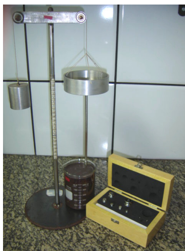
Figura 4.4 – Foto do aparato para teste de penetração.
