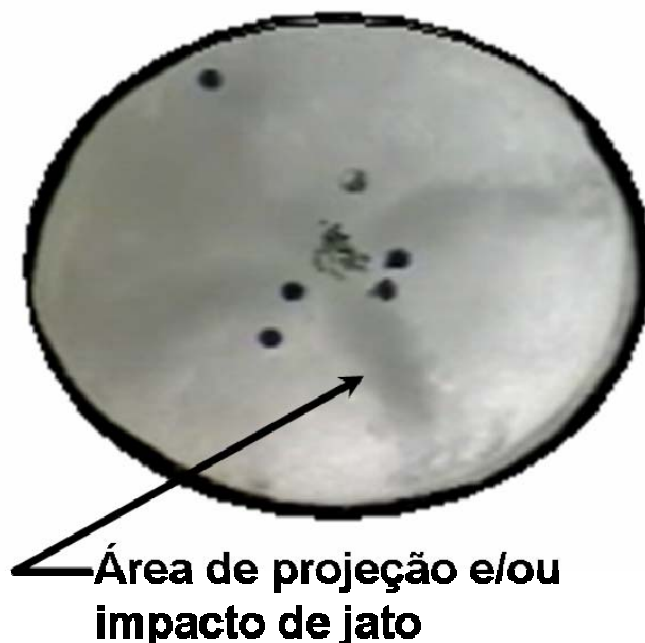
Figura 5.12 – Imagem ilustrando uma seção transversal horizontal vista do fundo do convertedor para o bico Rotox 20.
