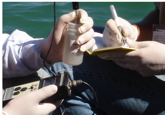
FOTO 5: Calibração do eletrodo para medição de parâmetros físico químicos de campo: pH, Eh, condutividade elétrica e temperatura.
