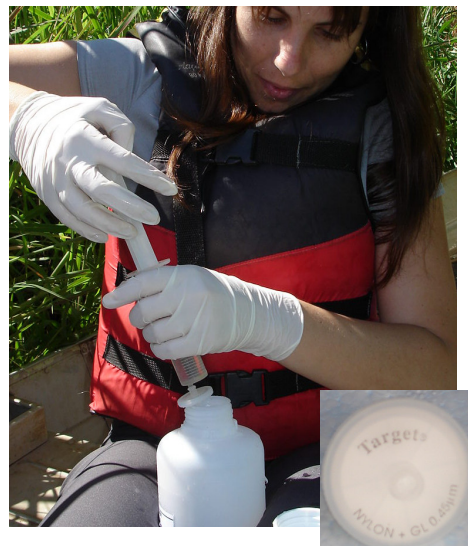
FOTO 2: Filtração de amostra em campo, utilizando elemento filtrante de nylon (0,45µm), para análise de metais solúveis - detalhe do filtro no canto inferior direito.
