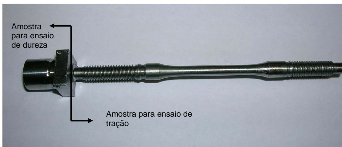
Figura 4.5: Região da retirada do corpo de prova para ensaio de dureza escala HRC.
