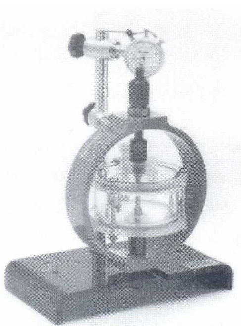
Figura 3.18: Esquema da célula de teste à CST de corpos de prova cilíndricos conforme método A da NACE TM0177/96 com inserção de carga segundo o método dos anéis.
