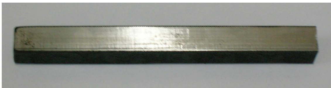
Figura 4.4: Corpo de prova utilizado para o tratamento na obtenção de amostras com variados tamanhos de grão de acordo com as propriedades definidas na tabela 4.3. Dimensões 150x13x13 mm.
