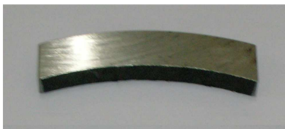
Figura 4.1: Corpo de prova utilizado para a medição da variação do tamanho de grão austenítico com a temperatura e tempo de austenitização. Dimensões 70 x 13 x 13 mm.
