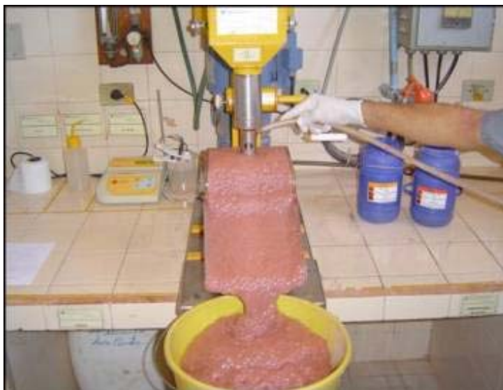
Figura 4.2: teste de flotação em espuma – Votorantim Metais.
