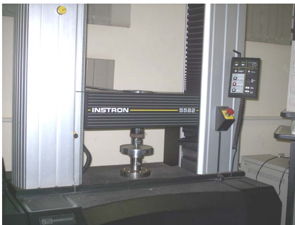
Figura 4.6 – Máquina de ensaios Instron realizando um ensaio de compressão.
