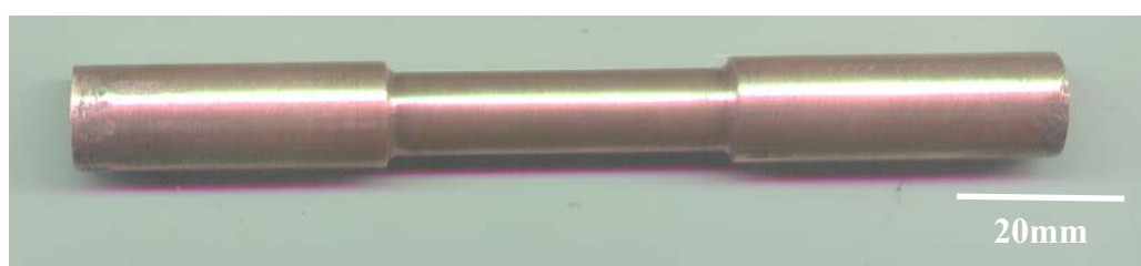
Figura 4.5 – Corpo de prova de tração utilizado para auxiliar na determinação relação entre microdureza e deformação.
