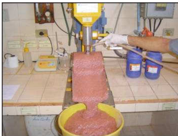
Figura 5.1: Teste de flotação em espuma – Votorantim Metais.
