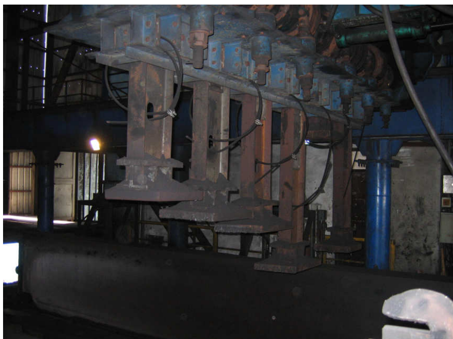
FIGURA 3.22: Martelos mecânicos para uma coqueria Heat Recovery com Compactação de Carga, na San Jia Coking Company, Cidade de Gao Ping, Província de Shanxi –China (Setembro de 2007)(17)
