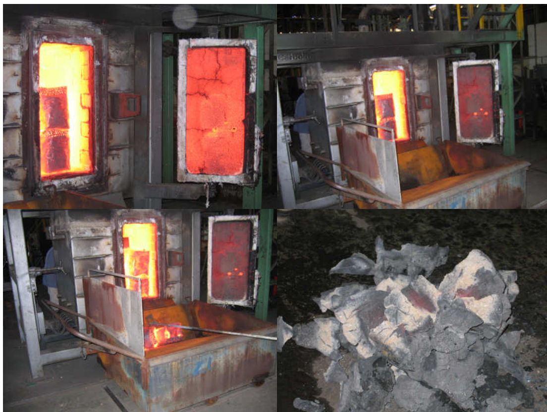
FIGURA 5.10: Seqüência de fotos do desenformamento de um forno com a carga compactada
