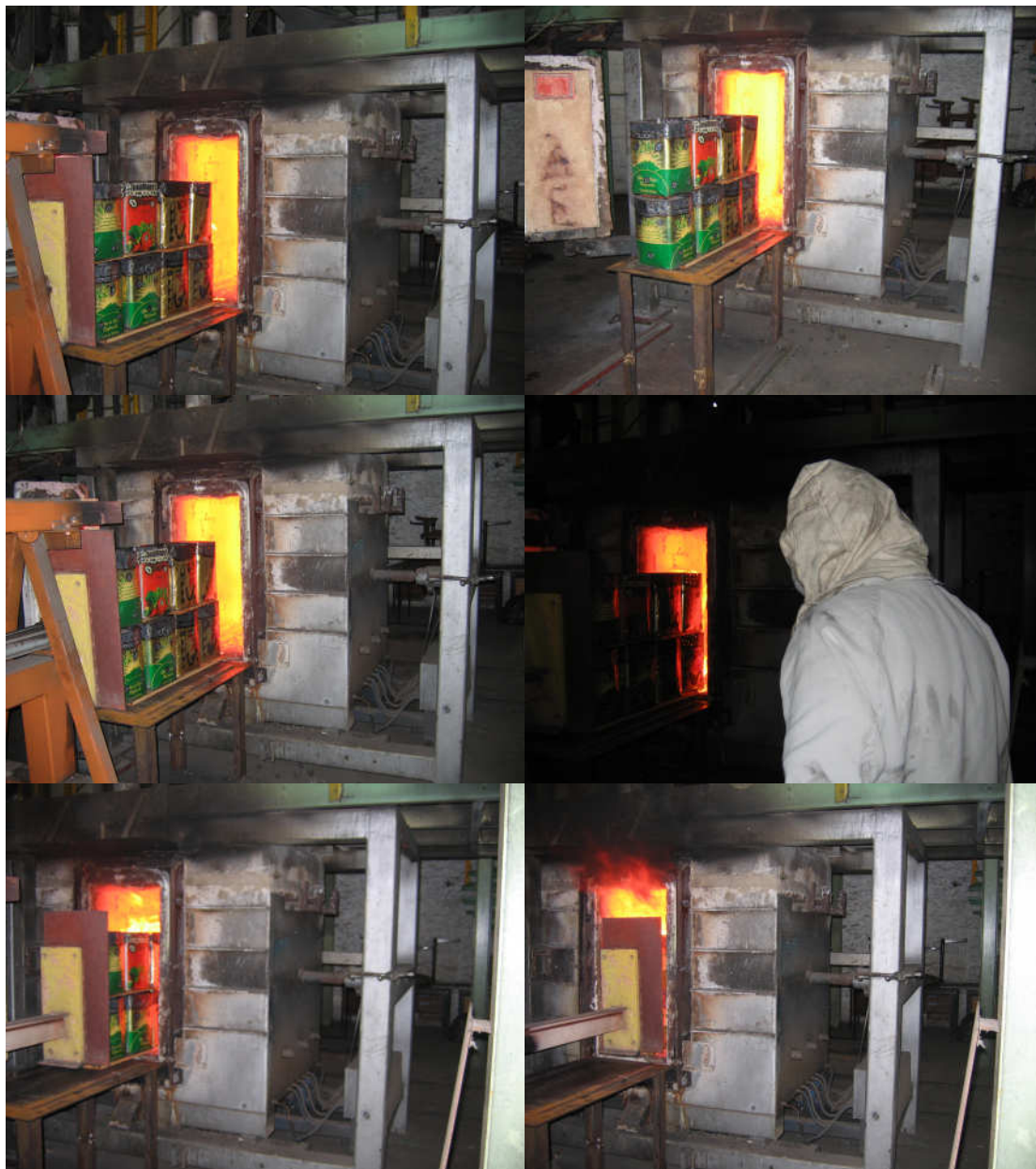
FIGURA 5.9: Seqüência de fotos de um enformamento “ stamp charging ” no forno piloto da Gerdau Açominas
