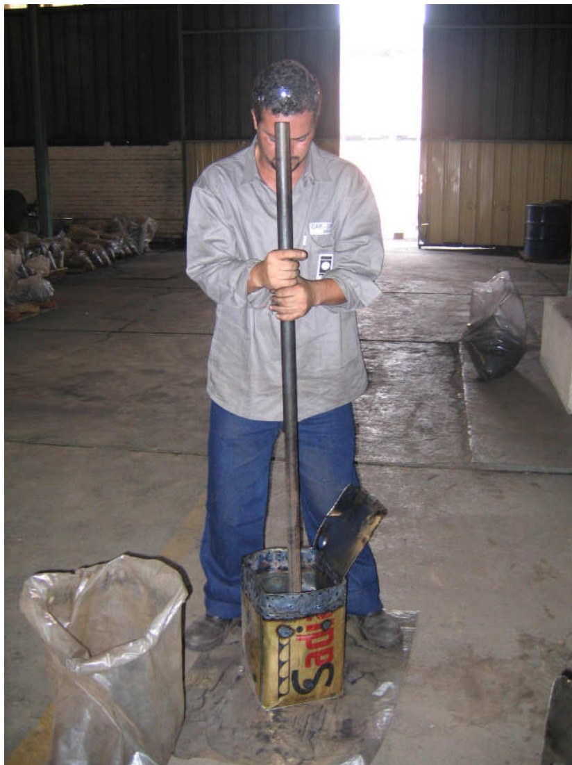
FIGURA 4.3: Operador “compactando” mistura na lata para teste “Stamp Charging” no forno piloto.
