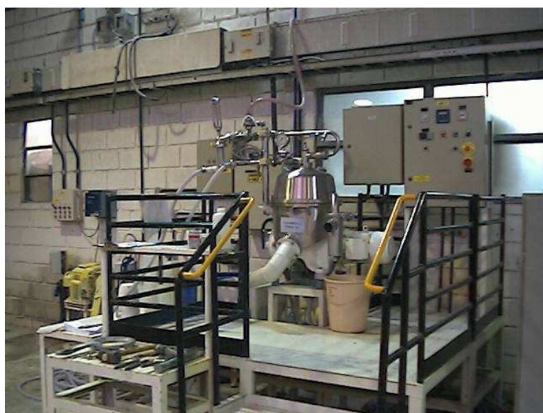
Figura 4.16: Centrífuga Centrífuga vertical piloto (Westfalia) – Utilizada na 2ª etapa
