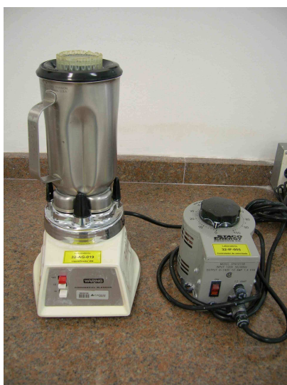
Figura 4.11: Condicionador de laboratório (Waring Blendor) – Utilizado na 2ª etapa
