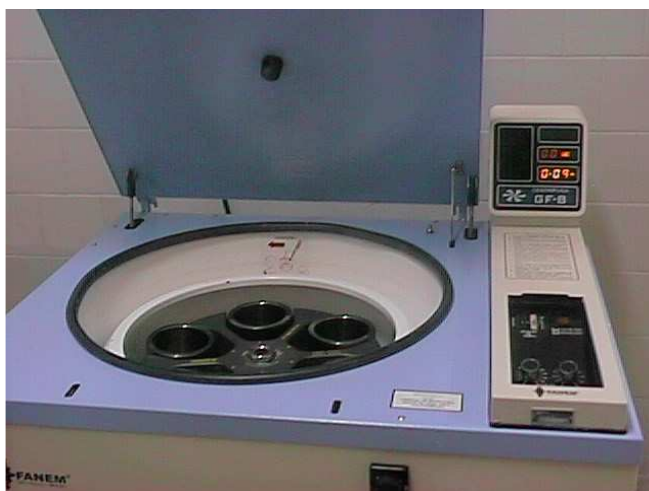
Figura 4.13: Centrífuga de laboratório Fanem (modelo GF-8) – Utilizada na 1ª etapa
