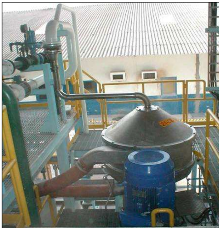
Figura 3.11: Centrífuga de disco Alfa Laval em operação na CADAM S/A
