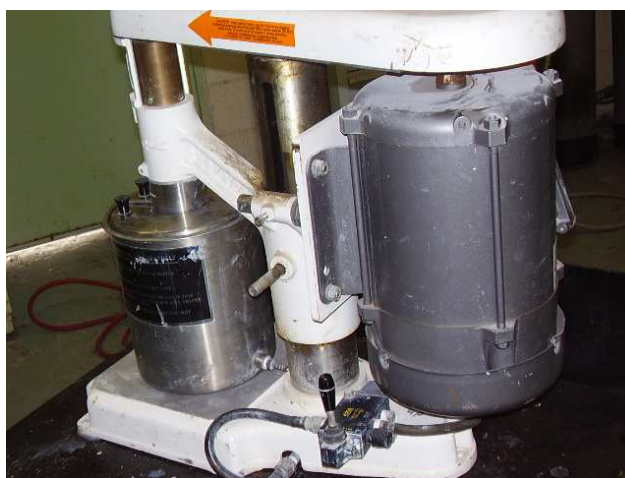
Figura 4.12: Condicionador piloto (Kady Mill) – Utilizado na 2ª etapa
