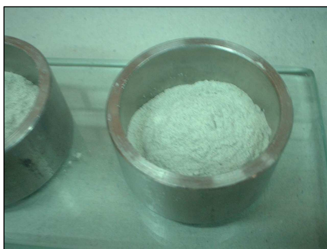
Figura 4.2: Caulim pulverizado dentro do anel metálico
