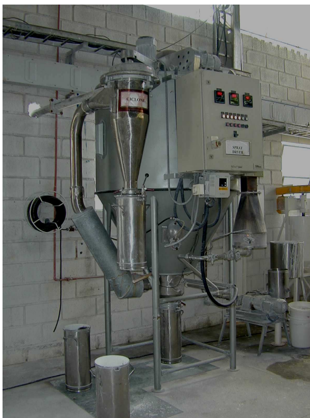
Figura 4.20: Spray Dryer piloto (Niro) – Utilizado em ambas as etapas
