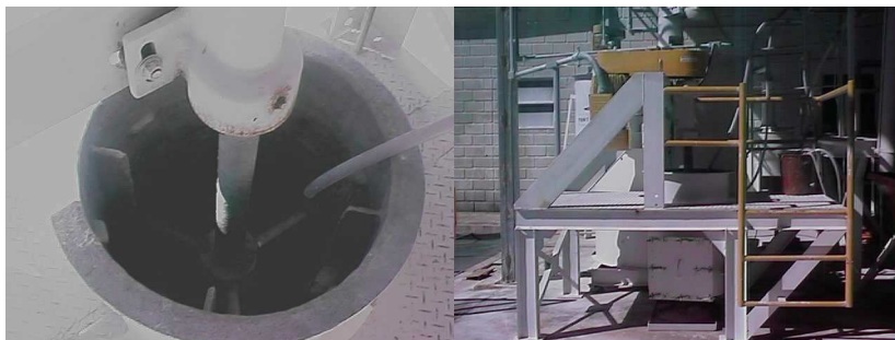
Figura 4.10 Dispersor da planta piloto (miniblunger) – Utilizado em ambas as etapas
