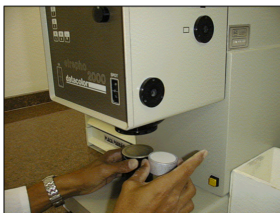
Figura 4.4: Anel metálico com caulim sendo colocado no espectrofotômetro
