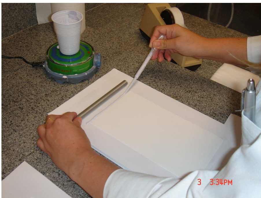
Figura 4.6 – Colocação da tinta sobre o papel para serem aplicados 10 \text{ g/m}^2
