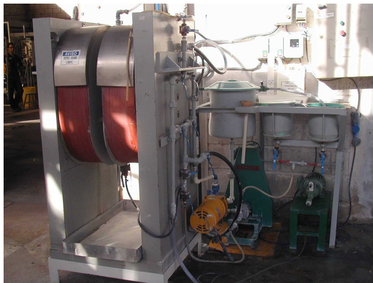
Figura 4.17: Separador magnético de laboratório (Eriez) – Utilizado em ambas as etapas
