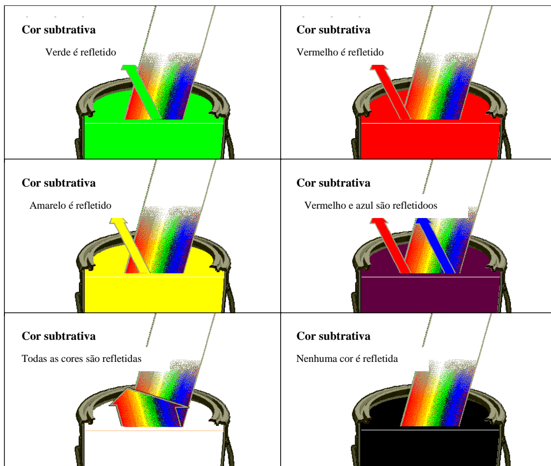
Figura 3.22: Exemplo de funcionamento das tintas. As coloridas refletem só a sua cor específica, a branca reflete todas as cores e a preta nenhuma.
