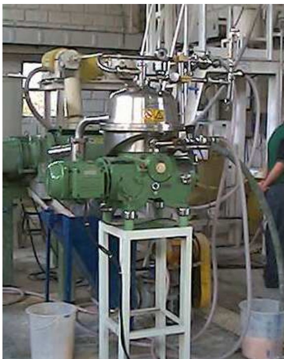
Figura 4.15: Centrífuga vertical piloto (Westfalia) – Utilizada na 1ª etapa
