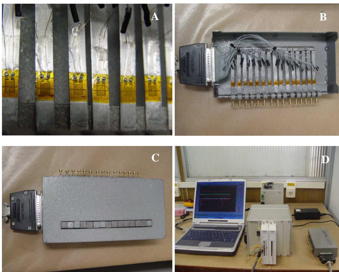
FIGURA 4.11 - Fotos da fixação dos strain gages nas alavancas (A), montagem das alavancas na base (B), alimentação com fios e fixação geral (C), e montagem completa do equipamento (D).
