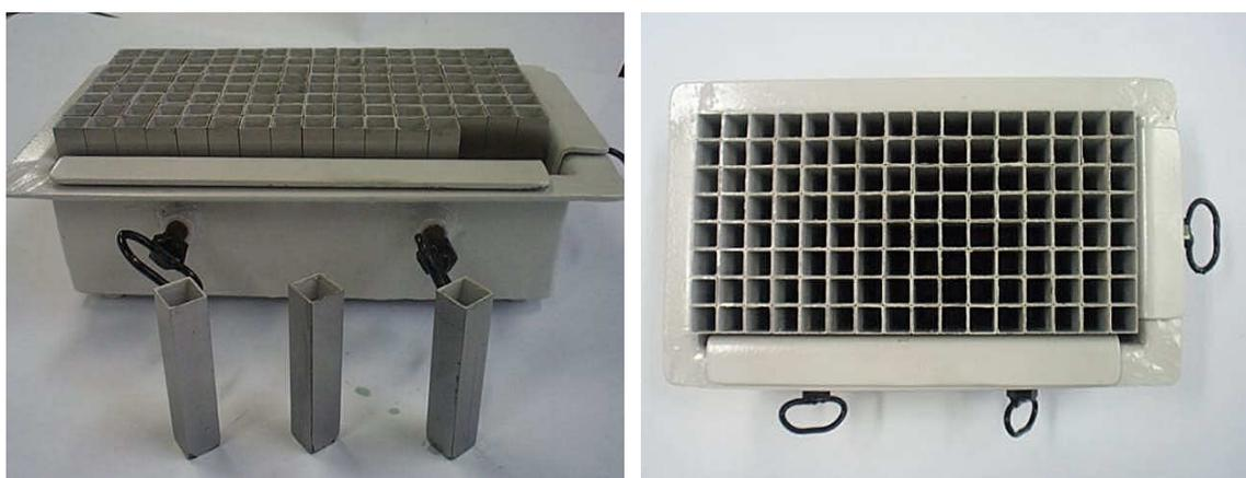
FIGURA 4.5 - Dispositivo para coleta e armazenamento da água atomizada destacando algumas células individuais.
