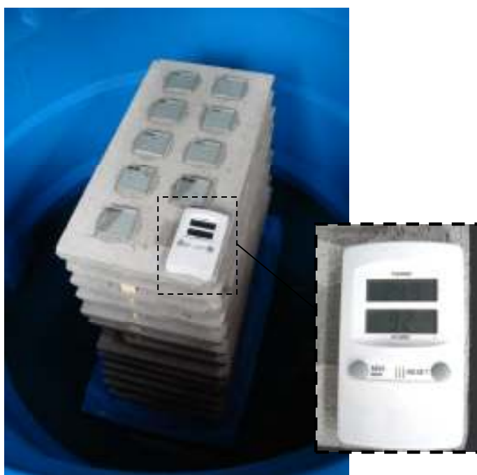
Figura 4.16– Condição de armazenamento das placas em ambiente com umidade elevada.
