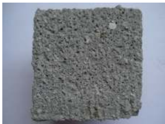
Figura 5.186 – Ruptura adesiva na interface argamassa modificada com polímero (PVA ou EVA)/substrato-padrão.
