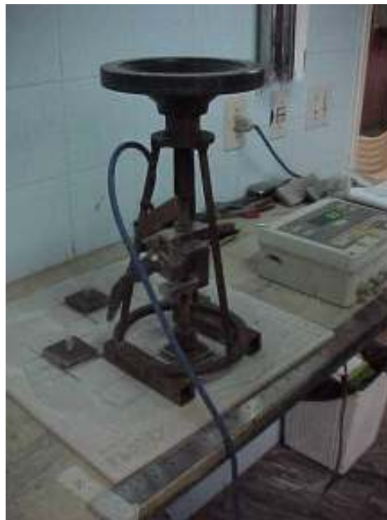
Figura 4.9 – Equipamento para determinação da resistência de aderência à tração acoplado à placa metálica quadrada colada na argamassa.
