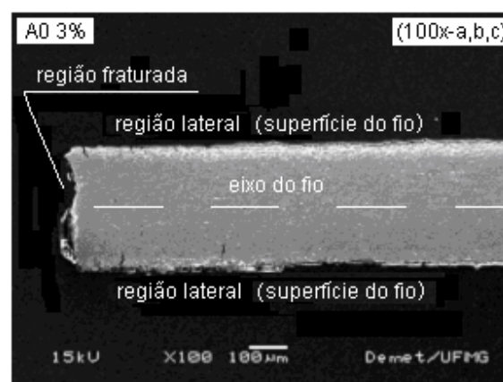
Figura 5.52 – Imagem de seção longitudinal de fio rompido, preparado para metalografia, ao MEV. Fio A0, \epsilon_a = 3\% , aumento de 100x, posições a,b,c do esquema na figura 5.56.
