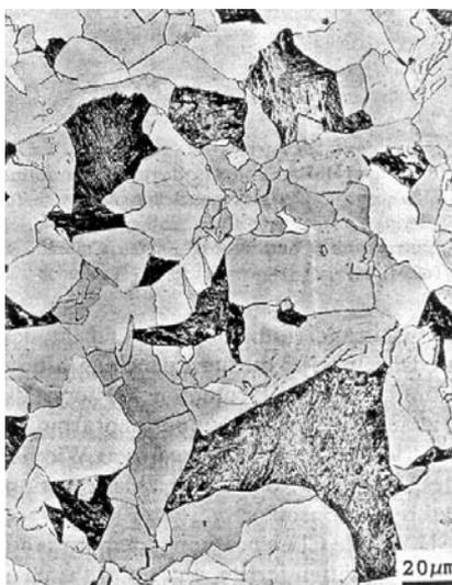
Figura 3.4 - Exemplo de microestrutura constituída de ferrita poligonal em aço HSLA 80, transformado isotermicamente a  $675^{\circ}\text{C}$  por 500 s. As áreas escuras são martensita formada durante têmpera da amostra<sup>36</sup>.
