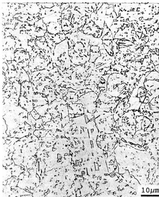
Figura 3.8 - Ferrita granular formada em resfriamento contínuo a 1°C/s de um aço baixo C com adições de Mn-Cu-Ni-Cr-Mo<sup>36</sup>.
