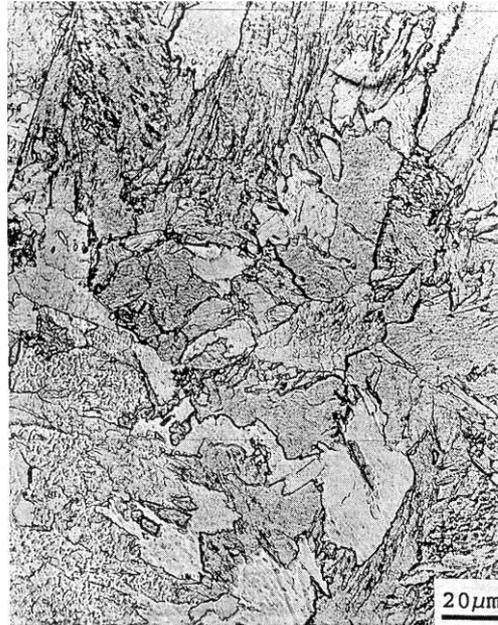
Figura 3.6 - Ferrita quasi-poligonal formada em um aço ultrabaixo C contendo 3% de Mn, resfriado a  $50^{\circ}\text{C/s}$ <sup>36</sup>.
