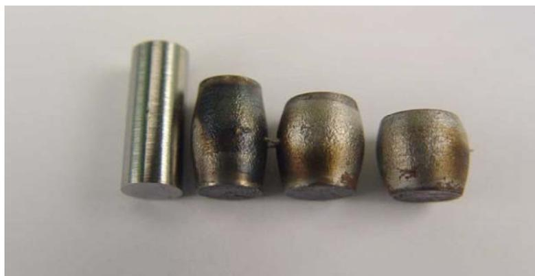
Figura 7.1 - Fotografia do corpo-de-prova original (primeiro à esquerda) e de corpos-de-prova após ensaios com deformações  $\varepsilon_1 = 0,25$ , e  $\varepsilon_2 = 0; 0,22; 0,36$ , nesta ordem, da esquerda para direita.
