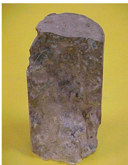
Figura 5. 8 – Modo de ruptura observado para corpo de prova do concreto com 15% de substituição de cimento por metacaulim, aos 91 dias de idade.
