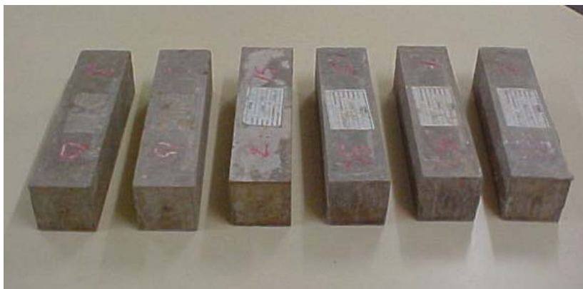
Figura 4. 3 – Corpos-de-prova prismáticos com dimensões de (7 x 7 x 28) cm.
