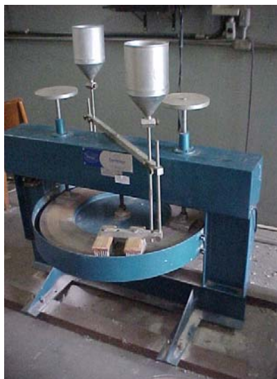
Figura 4. 6 – Máquina para ensaio de desgaste tipo “Amsler”.
