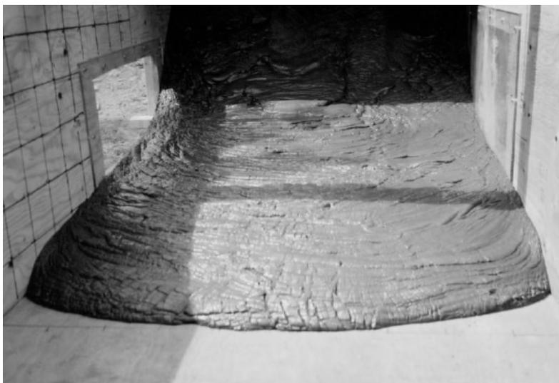
Figura 3.17: Perfil da pasta com 64% de sólidos e sem excesso de água. (Chambers et al., 2002)
