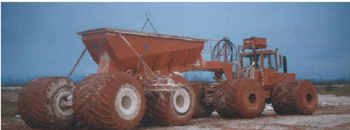
Figura 3.10: Transporte sobre rodas para a disposição superficial de pasta. (Lord, 2003)
