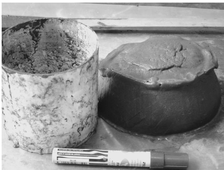
Figura 4.4: Cilindro “slump” de laboratório. (Hernández et al., 2005)
