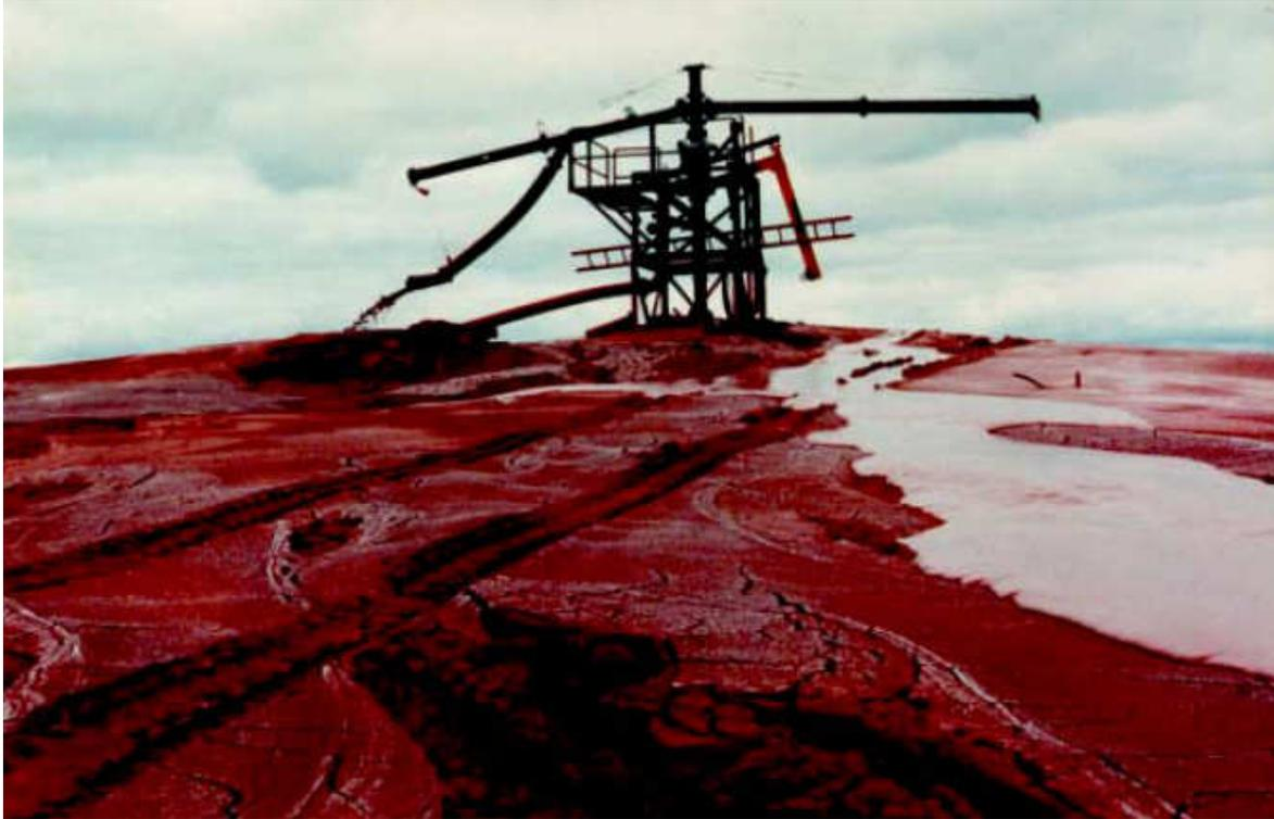
Figura 3.9: Descarga de pasta utilizando uma torre rotatória. (Lord, 2003)
