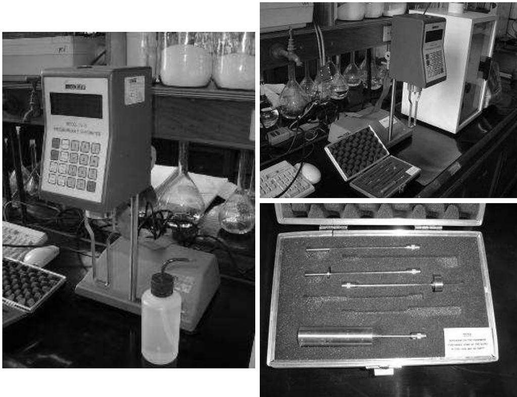
Figura 4.2: Viscosímetro Brookfield modelo DV-III com os “spindles” LV-1, LV-2, LV-3 e LV-4.
