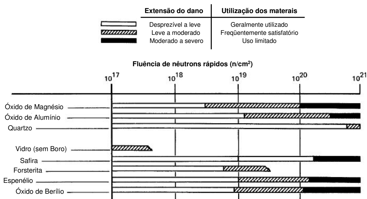
Figura 3.40: Resistência à radiação de materiais inorgânicos, baseado em alterações nas propriedades físicas (NATIONAL AERONAUTICS AND SPACE ADMINISTRATION, 1978)
