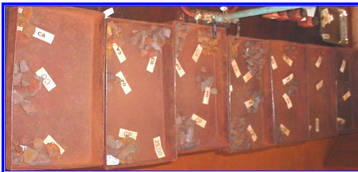
Figura 4.8 – Sistemática da separação tipológica dos fragmentos de minérios granulados, nas diversas faixas granulométricas, com auxílio de lupa de bolso e binocular.
