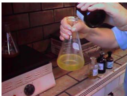
Figura 2 – Redução do ferro com cloreto estanoso.
