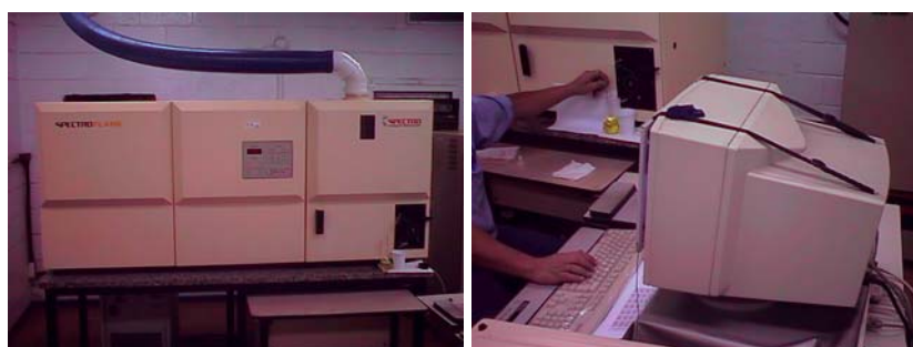
Figura 11 – Leitura das amostras no plasma.
