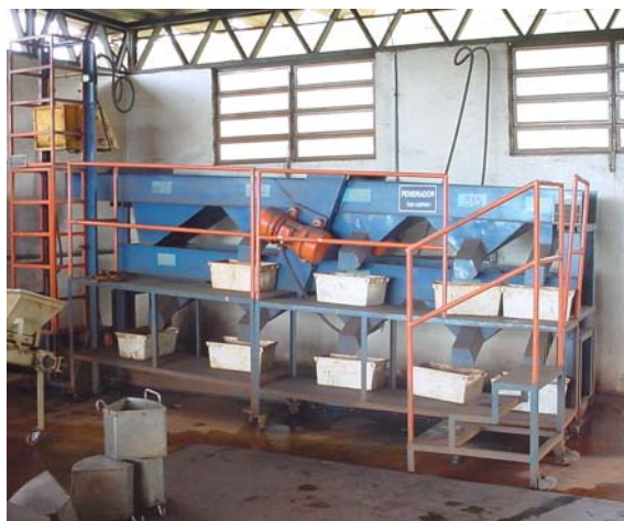
Figura 4.6 – Peneiramento das amostras nas faixas granulométricas padronizadas.
