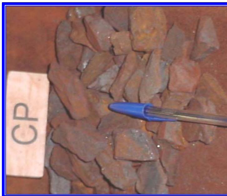
Figura 4.10 – Tipologia dos minérios compactos porosos.
