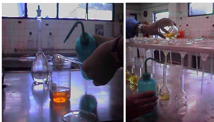
Figura 10 – Transferência da amostra solubilizada para o balão volumétrico.
