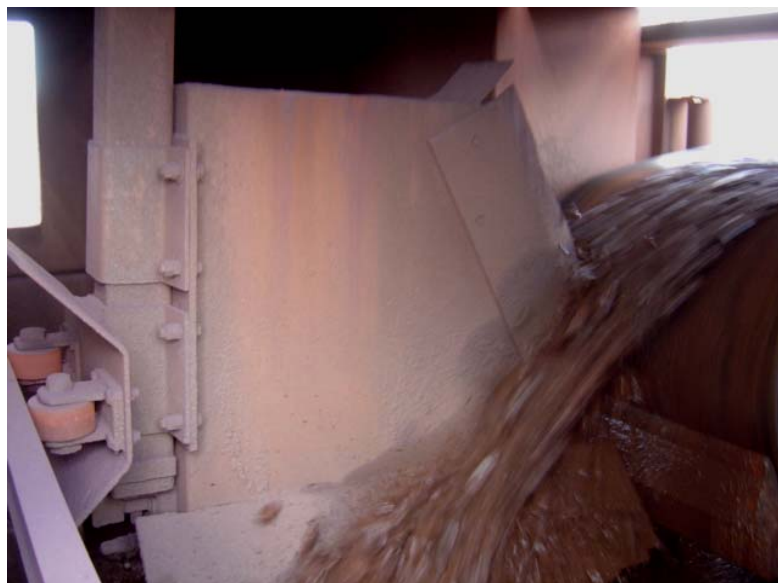
Figura 4.2 – Amostragem automática dos produtos granulados, sendo o fluxo de material na correia transportadora cortado integralmente pelo amostrador.
