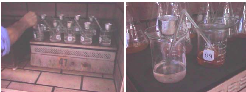
Figura 8 – Solubilização da amostra na chapa, após fundição na mufla.
