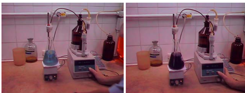
Figura 5 – Titulação com a mudança de coloração do azul para violeta.
