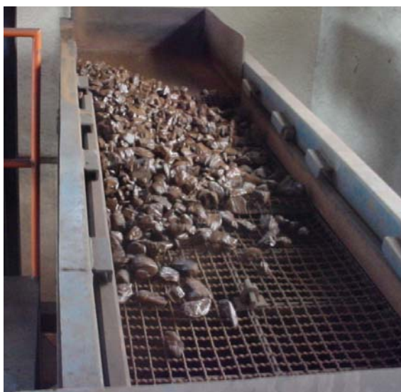
Figura 4.7 – Detalhe do peneiramento inicial na tela de 31,50 mm.
