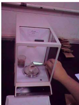
Figura 12 – Pesagem da amostra na balança analítica.
