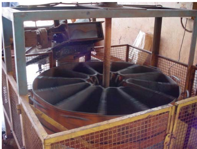
Figura 4.5 – Divisão (ou partilha) inicial da amostra em um sistema com sub-divisões que objetivam preservar a representatividade inicial da amostra.
