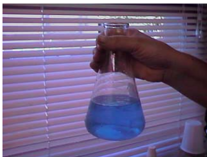
Figura 4 – Verificação da coloração ideal para titulação (azul).
