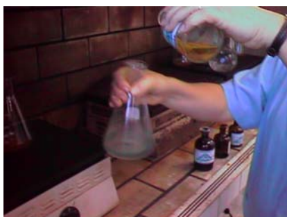
Figura 3 – Oxidação do excesso de TiCl_3 .
