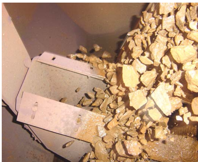
Figura 4.3 – Detalhe da amostragem automática dos granulados.
