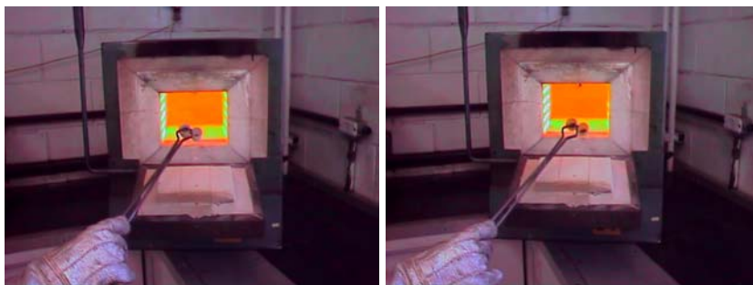
Figura 13 – Colocação da amostra na mufla para efetuar a perda por calcinação.
