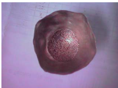
Figura 6 – Amostra e fundente no cadinho.
