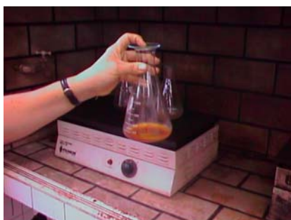
Figura 1 – Processo de solubilização do ferro na chapa.
