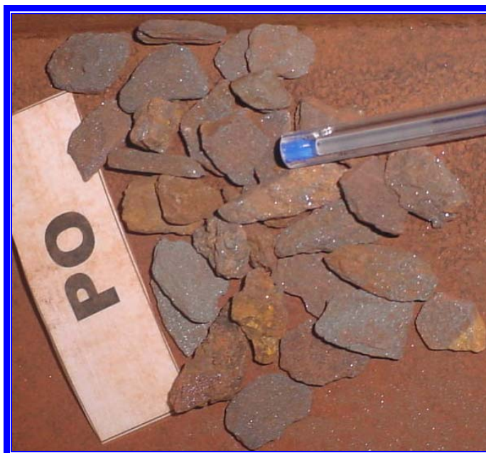
Figura 4.11 – Tipologia dos minérios porosos.
