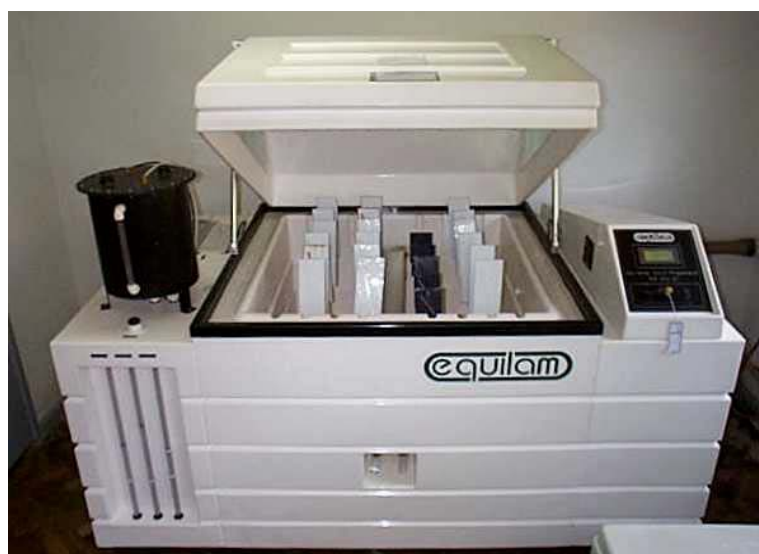
FIGURA 29 - Equipamento para testes de corrosão cíclicos Equilam - SSE 1000 Cíclico.
