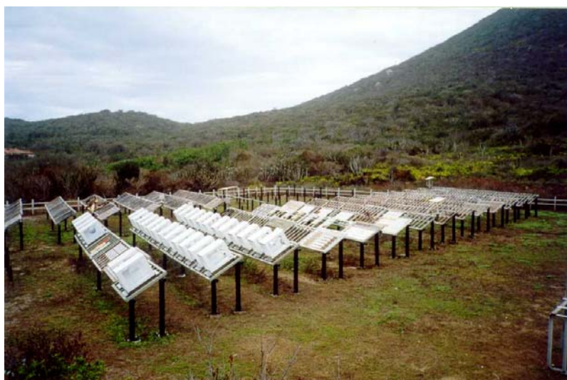
FIGURA 33 - Vista geral da Estação de Corrosão Atmosférica Marinha da Usiminas, localizada em Arraial do Cabo-RJ.
