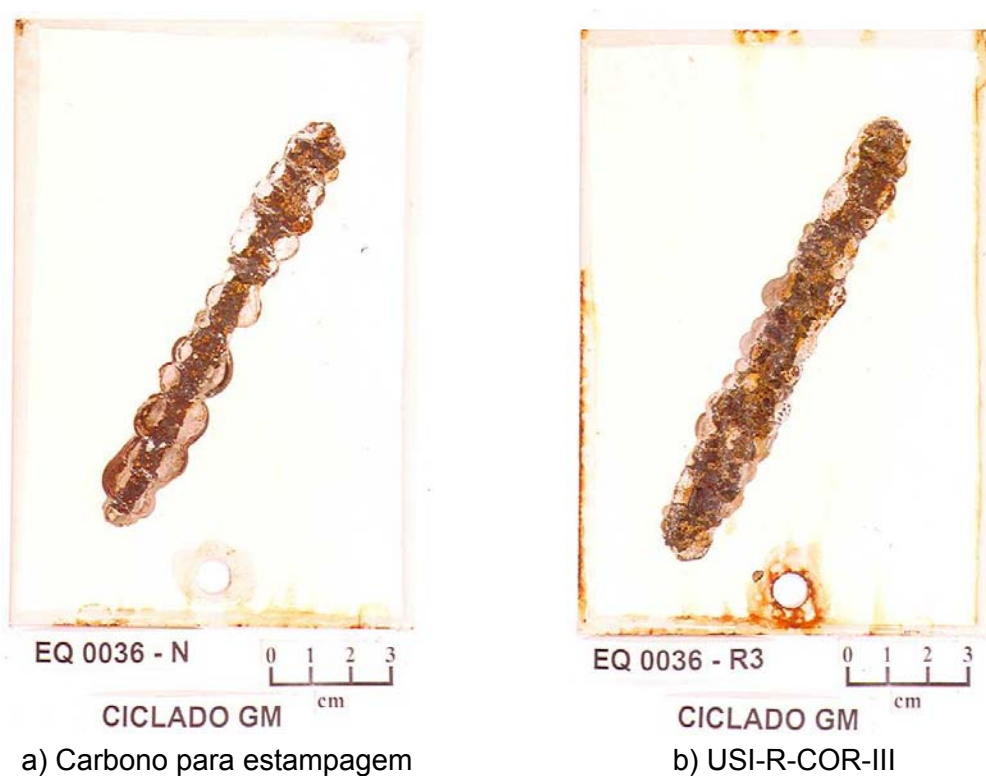
FIGURA 97 - Aspecto dos aços carbono para estampagem e USI-R-COR-III após 1920h de teste acelerado cíclico de corrosão GM 9540P/B.
