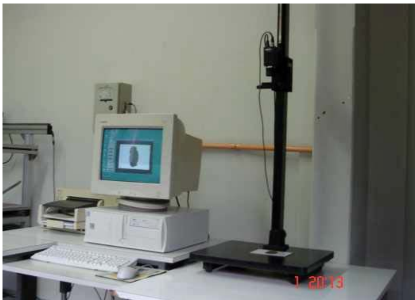
FIGURA 27 - Sistema utilizado para determinação do avanço médio da corrosão.
