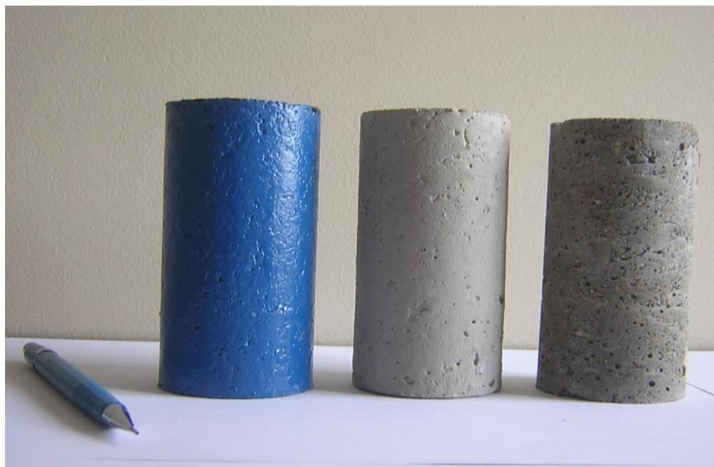
Figura 4.3 - Corpos de prova de 5x10cm de concreto protegido com borracha clorada, tinta acrílica e concreto sem proteção.
