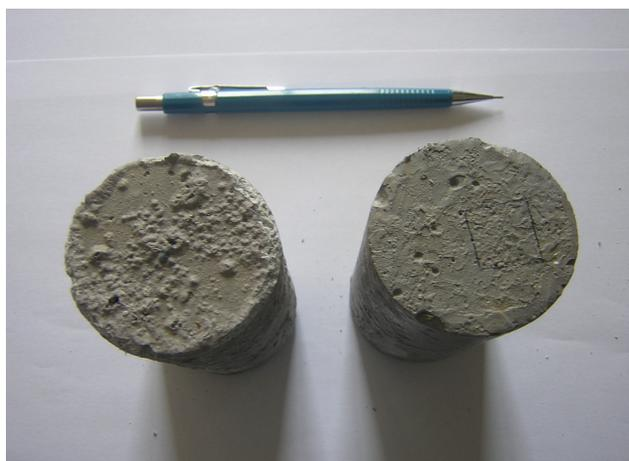
Figura 5.3 - Área varrida dos corpos de prova
