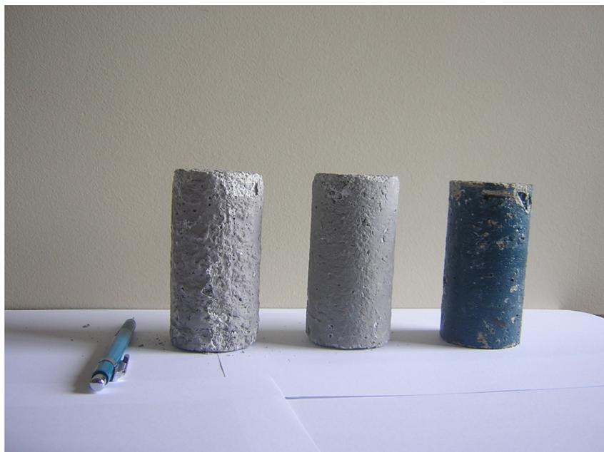
Figura 5.16 - Corpos de prova com proteção com tinta acrílica, selador/acrílica e borracha clorada, respectivamente da esquerda para a direita, após ataque químico de  $H_2SO_4$
