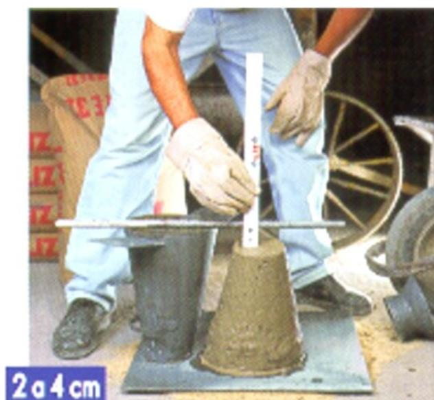
Figura 4.1 - Ensaio do abatimento do tronco de cone - "Slump"
