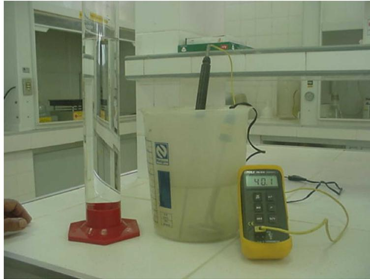
FIGURA 4.5 – Solução saturada de ácido clorídrico a 40°C.
