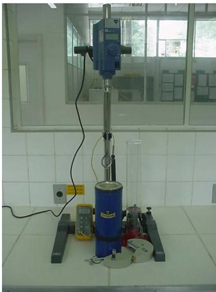
FIGURA 4.9 – Calorímetro aberto, com o medidor de temperatura e a tampa.
