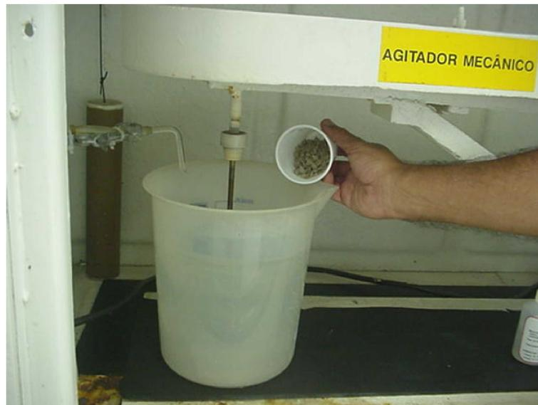
FIGURA 4.6 – Adição de 50g de amostra na faixa granulométrica de 10-40mm.
