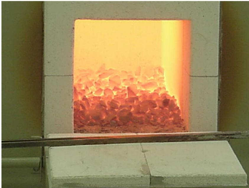
FIGURA 4.3 – Calcinação das amostras em mufla a  $1100^{\circ}\text{C}$  durante três horas.
