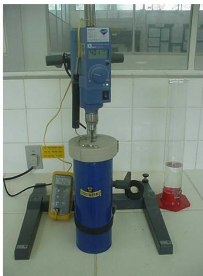
FIGURA 4.10 – Calorímetro fechado, com o agitador e o medidor de temperatura.
