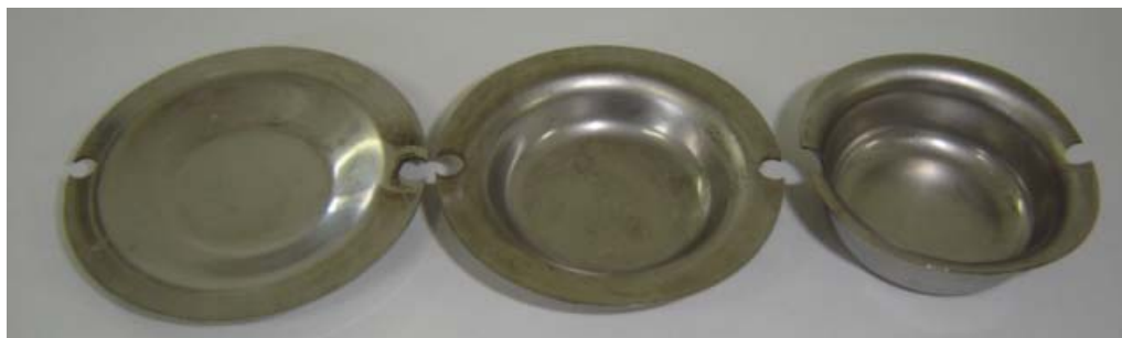
Figura 4.11: Exemplos de pré-formas da operação de embutimento nas quais foram cortadas amostras das zonas de deformação.
