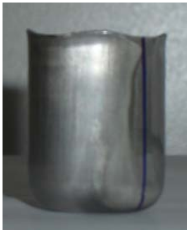
Figura 5.14: Copo embutido do aço 304B. As orelhas se formaram na direção diagonal em relação à direção de laminação que está representada pela linha traçada ao longo da parede do copo.
