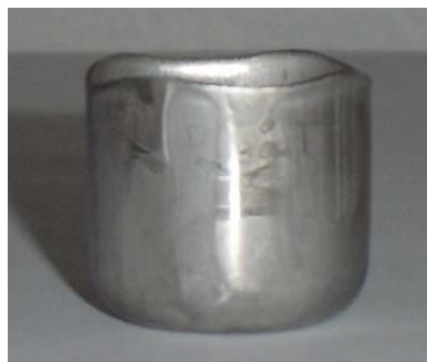
Figura 4.5: Copo embutido com blank de 56mm do aço 304 preparado para medição da microdureza.
