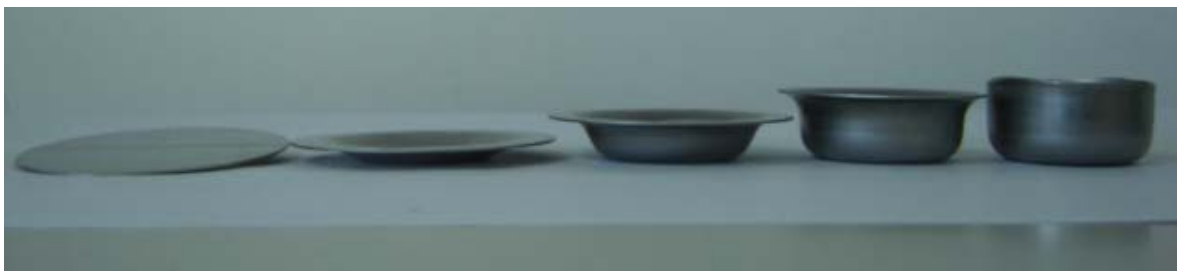
Figura 5.58: Estágios da operação de embutimento dos aços inoxidáveis austeníticos.
