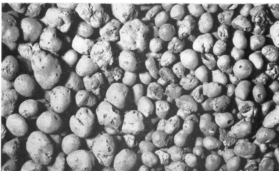
Figura 1. 2 – LECA, agregado de argila expandida manufaturada em forno rotativo.
