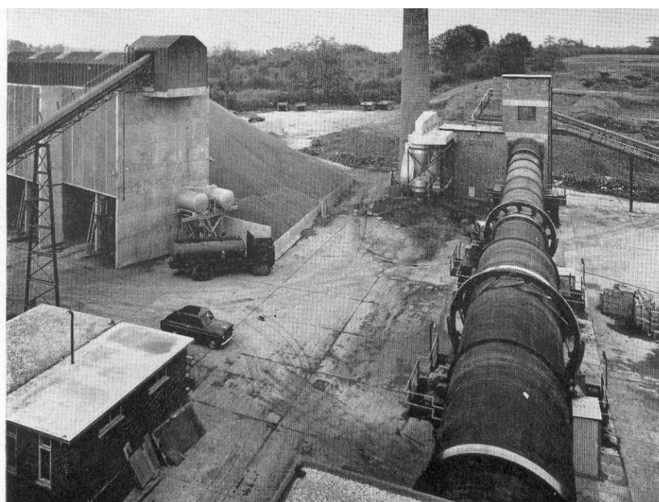
Figura 1. 3 – Forno rotativo usado para produção de argila expandida Fonte: SHORT e KINNIBURGH (1963).
