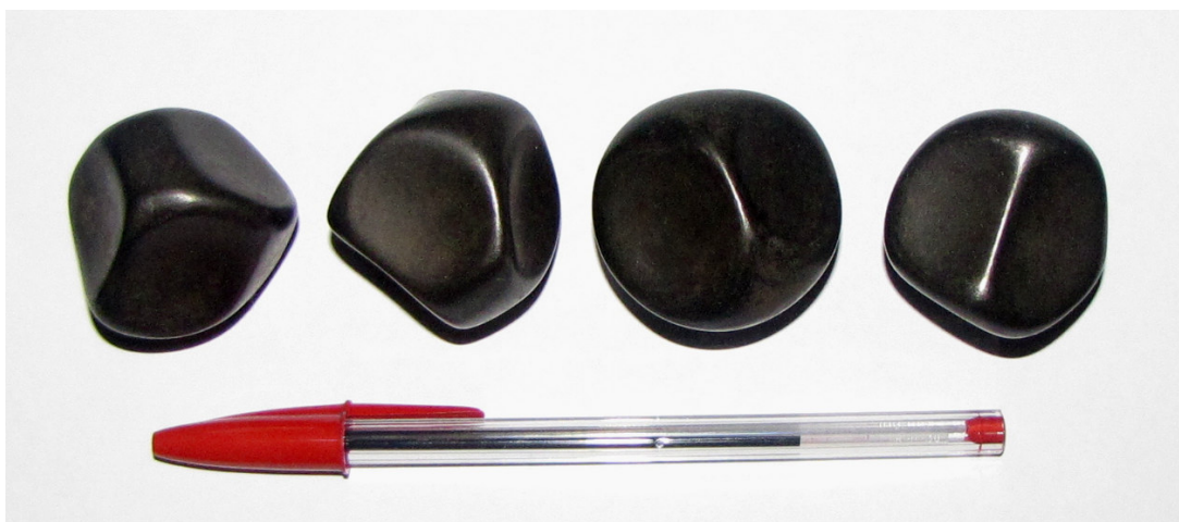
Figura 5.2 - Exemplo de bolas expuldas do moinho durante a operação.
