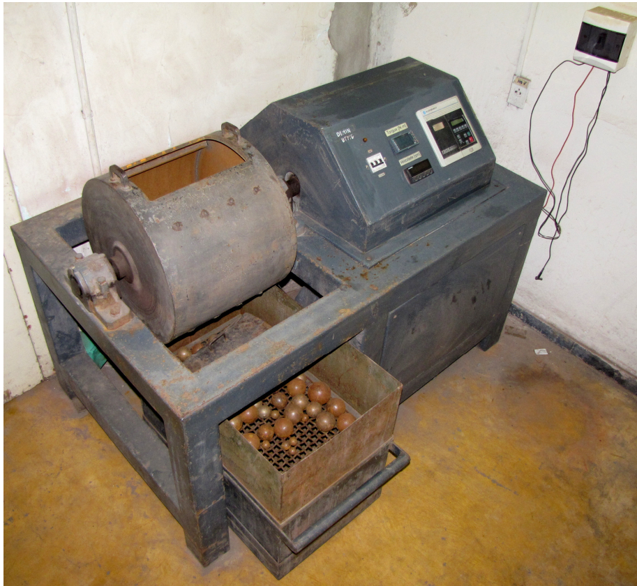
Figura 5.4 - Moinho de laboratório com sensor de torque - Laboratório de Tratamento de Minérios do Departamento de Engenharia de Minas - UFMG.
