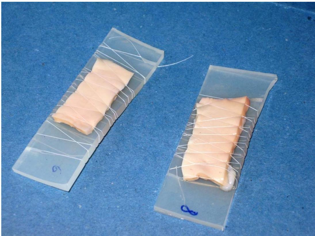
**Figura 4-3 - Opção de fixação do tecido biológico à placa de silicone com linha**
