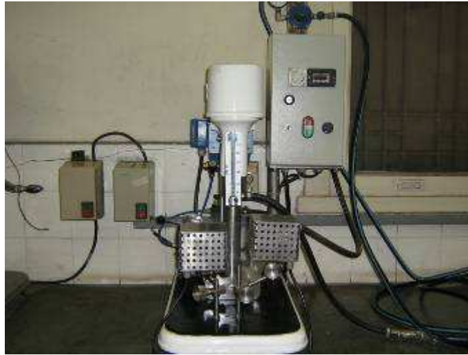
FIGURA 4.5: Célula de flotação CDC do Laboratório de Tratamento de Minérios – DEMin.
