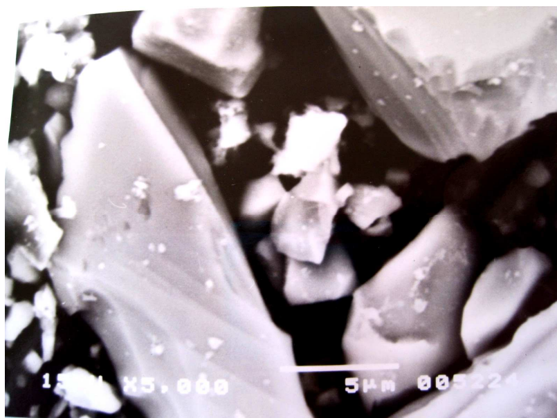
Figura IV-11- Precipitados com características semelhantes às do precipitado “a” cuja análise não acusa a presença de ferro
