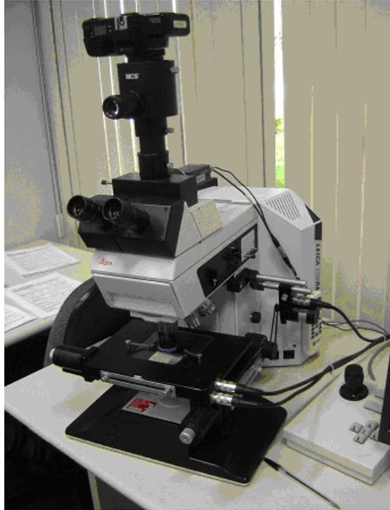
Figura 5.8 Microscópio óptico do laboratório de métodos físicos do Centro de Pesquisas da ArcelorMittal Inox Brasil.
