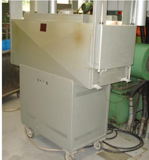
Figura 6.11 Forno elétrico de dupla abertura do tipo EDG
