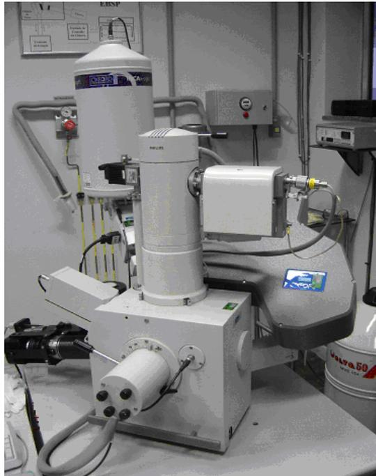
Figura 5.9 Microscópio eletrônico de varredura do laboratório de métodos físicos do Centro de Pesquisas da ArcelorMittal Inox Brasil.
