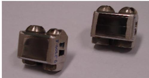
Figura 5.6 Amostras para análise em microscopias óptica e eletrônica de varredura (MEV) provenientes das tiras após laminação piloto.
