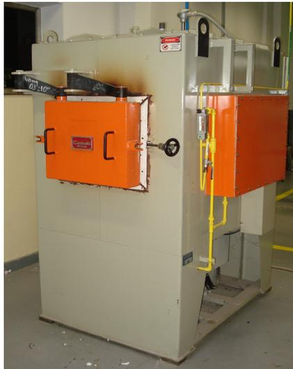
Figura 6.10 Forno elétrico de câmara do tipo global, modelo FEG-25/60/20, fabricado pela Combustol Industria e Comercio Ltda
