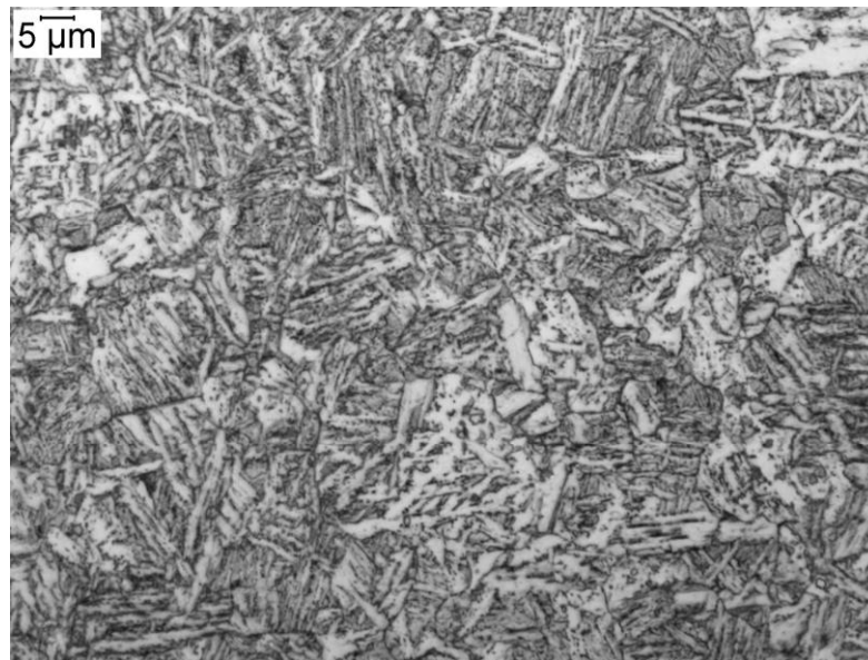
FIGURA 3.12 – Micrografia típica de ferrita poligonal nucleada totalmente no interior do grão austenítico (algumas regiões clara) (14) .
