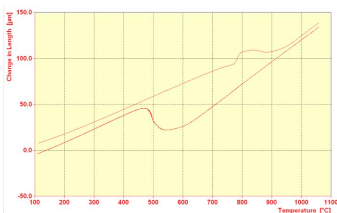
FIGURA 5.8 – Gráfico típico obtidos no dilatômetro após aferimento dos parâmetros de ajuste de ruído do Software de aquisição de dados.
