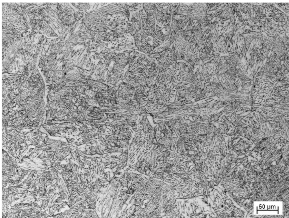
(a) Aço LN – Aporte térmico de 35 kJ/cm – Próximo ao termopar
