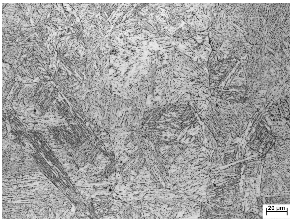
(d) Aço LC – Aporte térmico de 10 kJ/cm – fratura frágil
