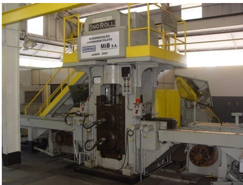
FIGURA 4.2 – Laminador Piloto utilizado na laminação dos lingotes.
