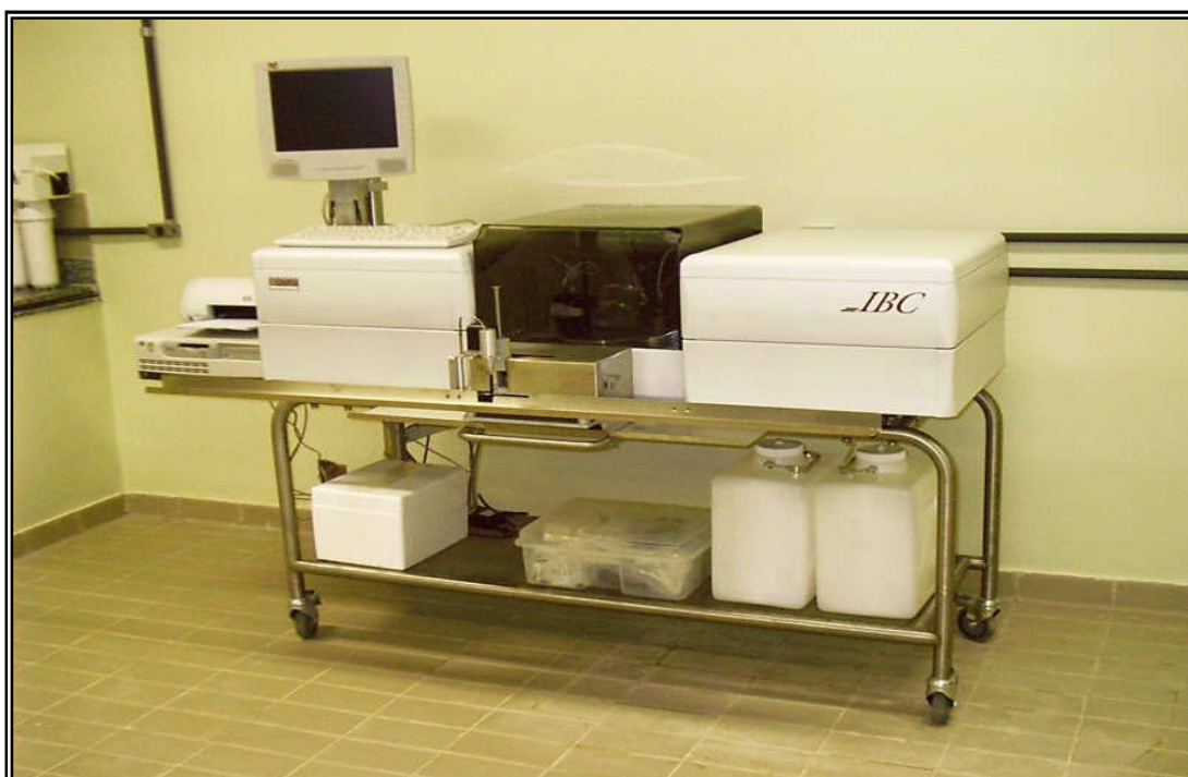
Figura 2.3. Foto de equipamento eletrônico IBC BactoCount IBC da Bentley Instruments Incorporated®, Chaska, Estados Unidos da América, para contagem bacteriana total em amostras de leite cru.
