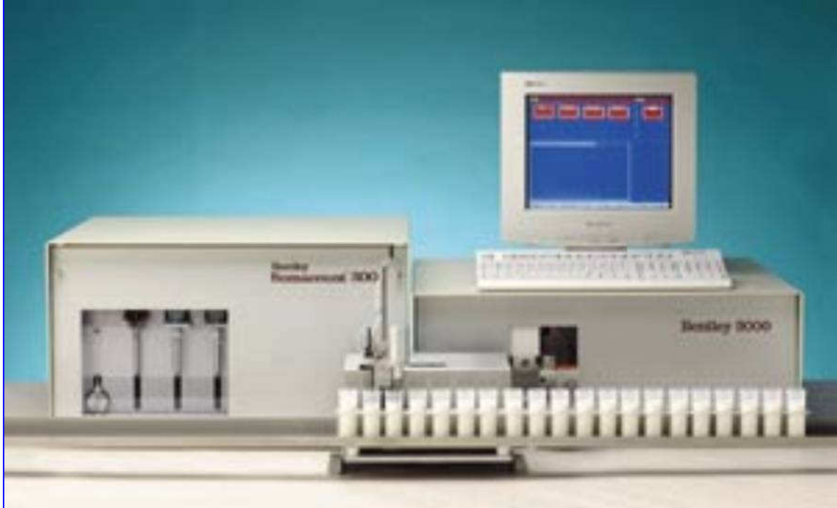
Figura 2.4. Foto de equipamento eletrônico Bentley Combi System 2300 ® , Chaska, Estados Unidos da América, para contagem de células somáticas e análise de composição centesimal de amostras de leite cru.
