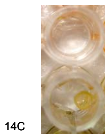
Figura 14. A. Representação esquemática do processo de reticulação química e formação dos híbridos com os agentes silane modificadores. B. Híbridos resultantes do PVA 107 modificado pelo grupo glicidil (PVA 107/GPTMS - filme) e reticulado com GA (PVA 107/GA/GPTMS - disco). C. Híbridos resultantes do PVA KM 118 modificado pelo grupo glicidil (PVA KM 118/GPTMS - filme) e reticulado com GA (PVA KM 118/GA/GPTMS - disco).
