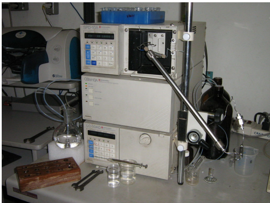
Figura 3-2. Equipamento de cromatografia líquida de alta eficiência. Shimadzu modelo LC 10 AD.
