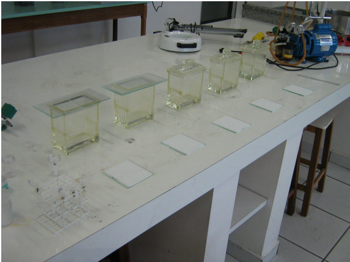
Figura 3-1. Análises cromatográficas em camada delgada com placas de vidro 10 x 10 cm, com adsorvente de sílica F e revelador de vapor de iodo ressublimado.
