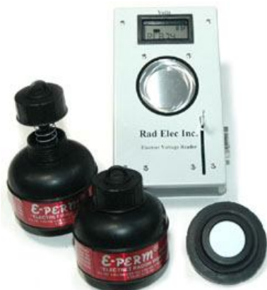
Figura 3.2 – Câmara de ionização E-PERM
