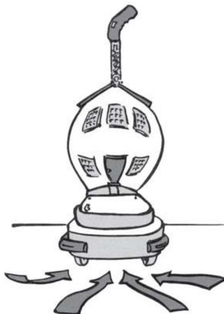
Figura 2.4 – Ilustração da convecção do radônio a partir do solo. Fonte: EPA (2006)
