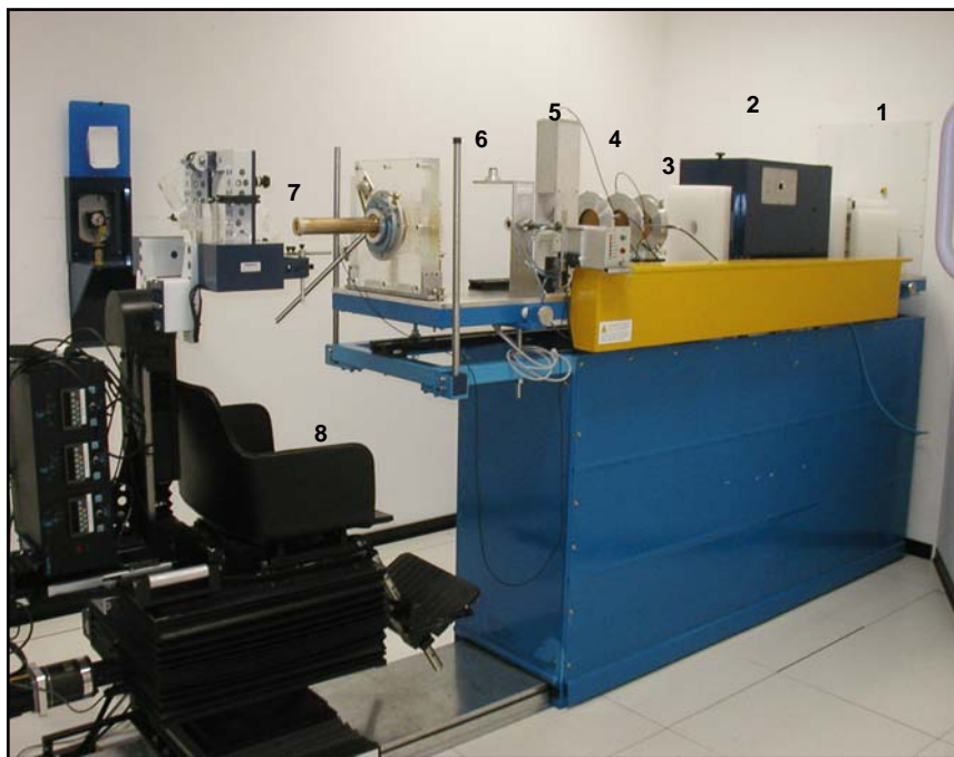
FIGURA 21. Foto da instalação de irradiação do CATANA: 1. Sistema de Espalhamento, Kapton Window e Stopper ; 2. Caixa Contendo o Modulador e o Absorvedor; 3. Colimador Intermediário; 4. Câmaras de Monitoração; 5. Campo de Luz; 6. Posicionamento do Laser; 7. Colimador Final; 8. Cadeira de Tratamento com Imobilização do Paciente.
