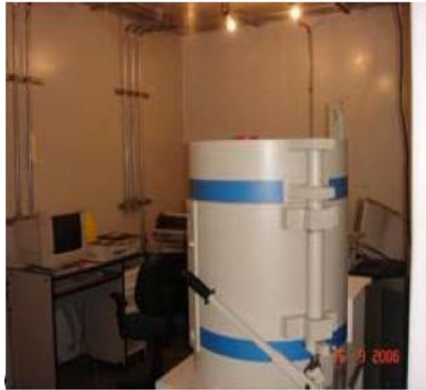
Figura 9 - Blindagem e sala blindada do detector (CUCCIA, 2006)
