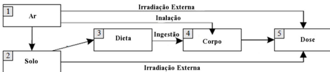
Figura 3 – Vias terrestres da transferência de radionuclídeos e a dose no corpo – (Modificado de UNSCEAR, 2000)
