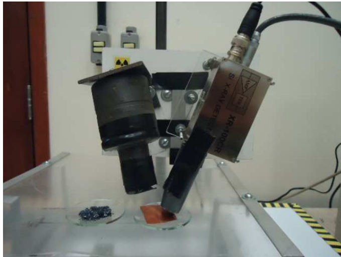
Figura 50 Calibração realizada com os elementos químicos cobre e iodo.
