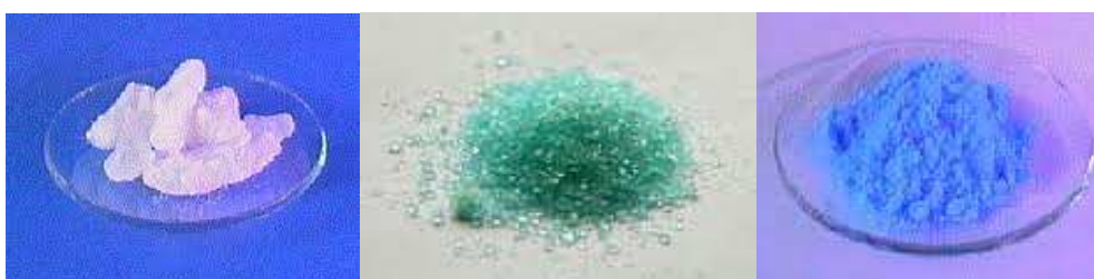
Figura 53 Amostras usadas na aquisição. A) Nitrato de bismuto \text{Bi}_5(\text{OH})_9(\text{NO}_3)_4 B) Sulfato ferroso \text{FeSO}_4 \cdot \text{H}_2\text{O} C) Sulfato de cobre \text{CuSO}_4 \cdot 5\text{H}_2\text{O}
