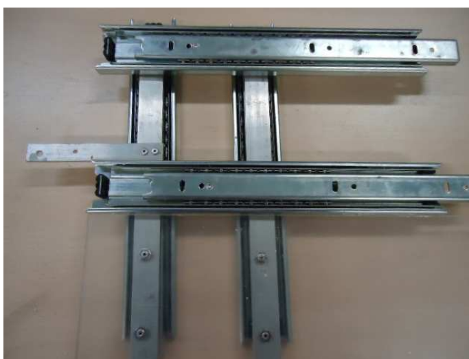
Figura 12 Trilhos deslizantes utilizados para a movimentação nos eixos x e y.
