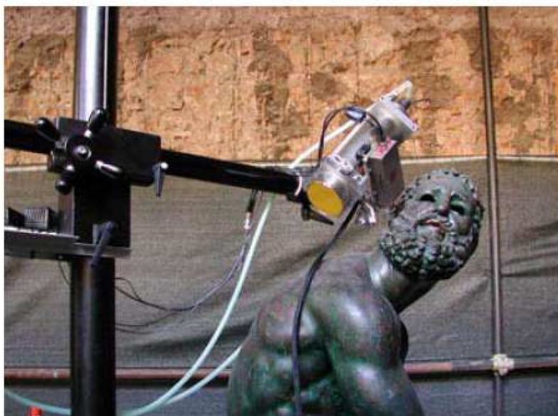
Figura 7 Análise não destrutiva com FRX sobre o “Pugilista”, estátua de bronze do período helenístico exposta no Museu Nacional de Roma.
