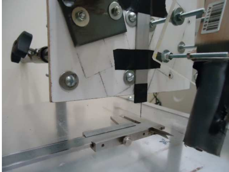
Figura 35 Mecanismo adaptado para medição de resolução da varredura XY da mesa.
