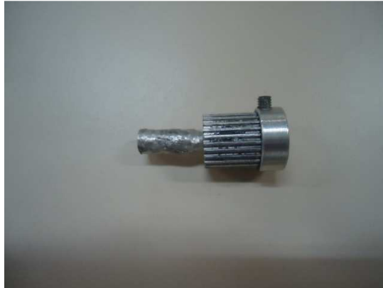
Figura 19 Sistema de polias do sistema de movimentação. a) polia do motor com extensor para fixação do encoder.
