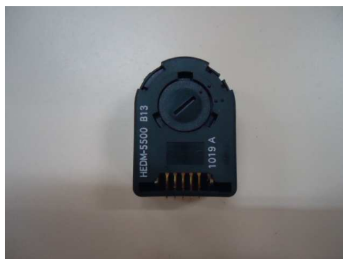
Figura 24 Vista frontal do encoder HEDM-5500
